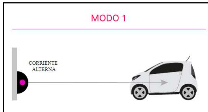
Figura 18. Modo 1 de recarga de VE
