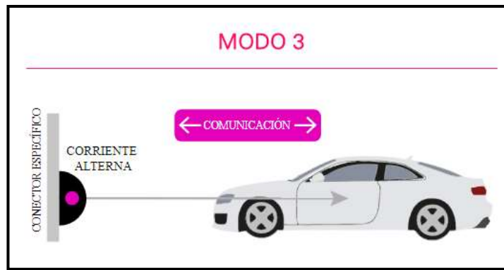
Figura 20.. Esquema del modo 3 de recarga de VE Fuente: Endesa (2017). Descubre los distintos modos de recarga que puedes encontrar en el mercado. Endesa vehículo eléctrico Editado por: Luis Fabre
