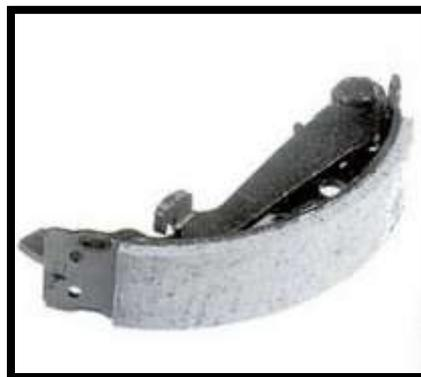
**Figura 9. Zapata de freno**
