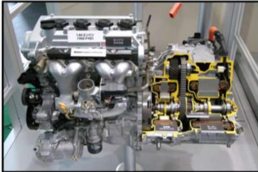
**Figura 25:** Motor y caja de cambios del Toyota Prius.
