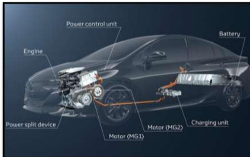
**Figura 24:** Componentes del sistema híbrido del Toyota Prius
