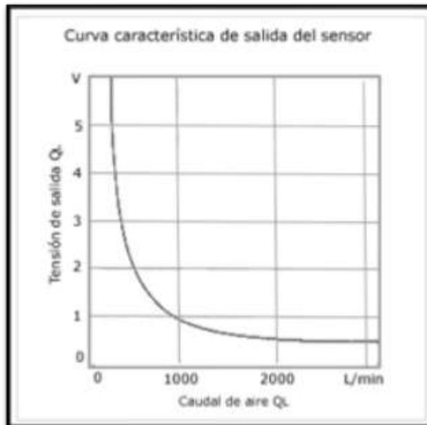
**Figura 12:** Curva de funcionamiento sensor MAF.
