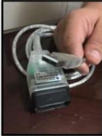
**Figura 45:** Extremo tipo USB del interfaz Mongoose.
