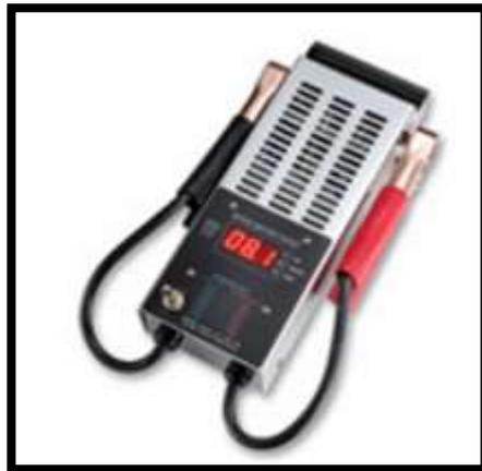
**Figura 10.** Comprobador de batería
