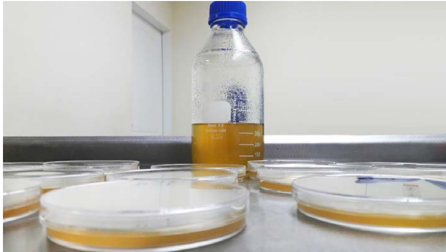
Ilustración 12: Colocación de Agar base sangre en cajas petri con muestras
