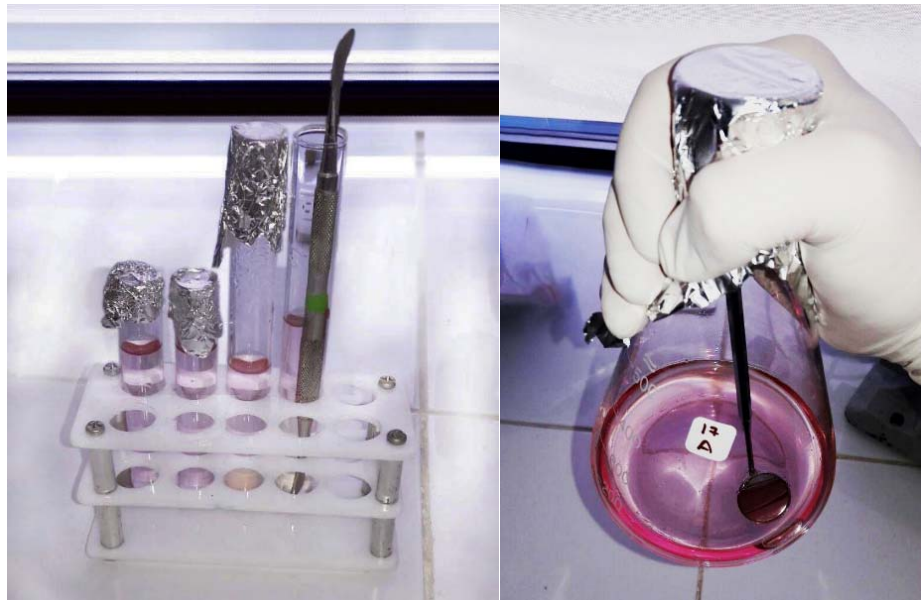
Ilustración 4: Toma de muestra previo a la desinfección
