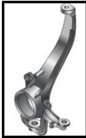
**Figura 5.** Mangueta y buje
