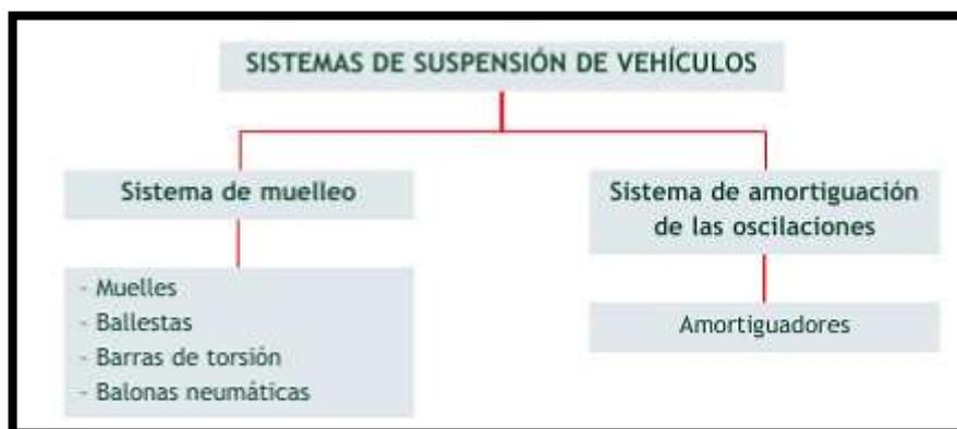
**Figura 2.** Sistema de suspensión de automóviles
