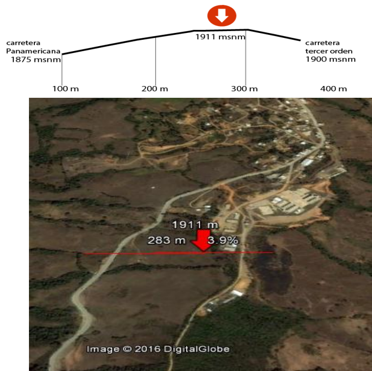
Ilustración 18. Corte transversal del terreno
