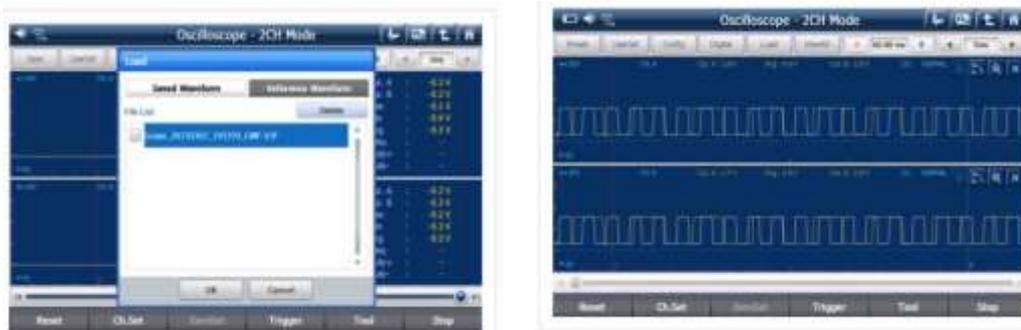
Imagen N°38. Comparación con la forma de onda cargada.
