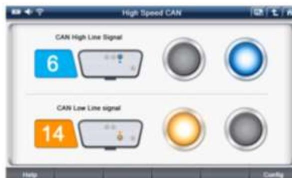
Imagen N°19. Inspección línea CAN
