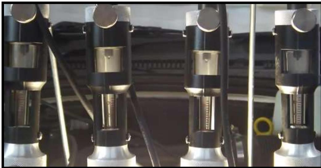
**Figura 40.** Prueba de estanqueidad a 1000 bares
