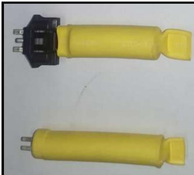
**Figura 13.** Simulador de la válvula reguladora presión
