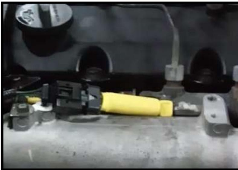
**Figura 27.** Simulador de la válvula IMV
