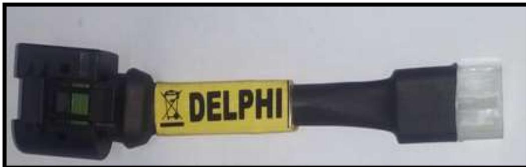
**Figura 38.** Simulador de presión del riel
