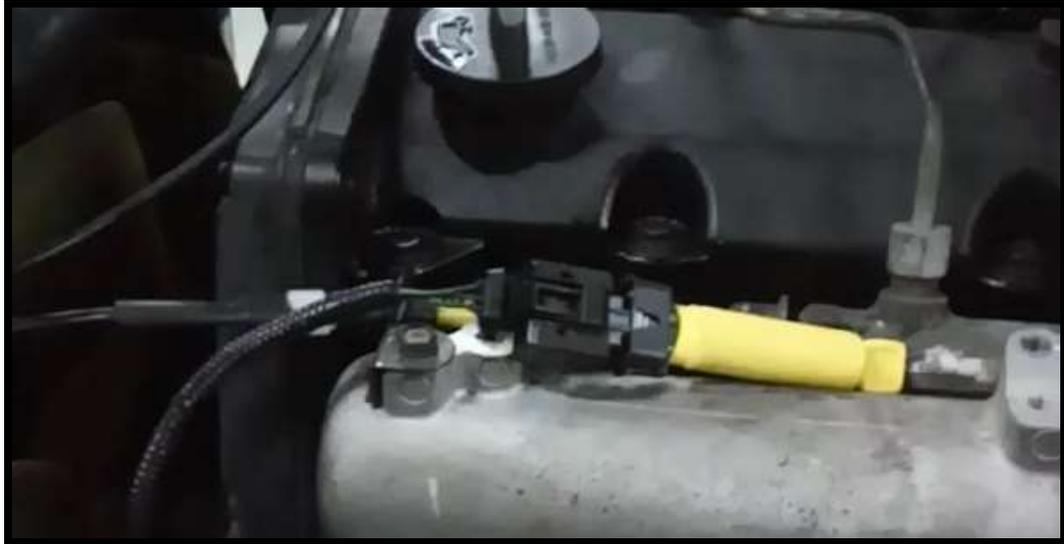
**Figura 19.** Simulador de la válvula reguladora de presión IMV
