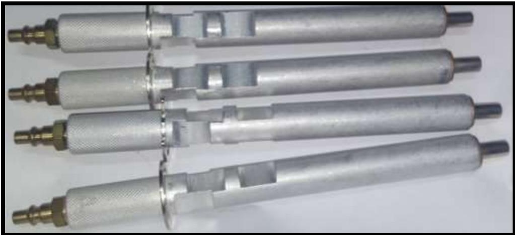
**Figura 14.** Inyectores sustitutos
