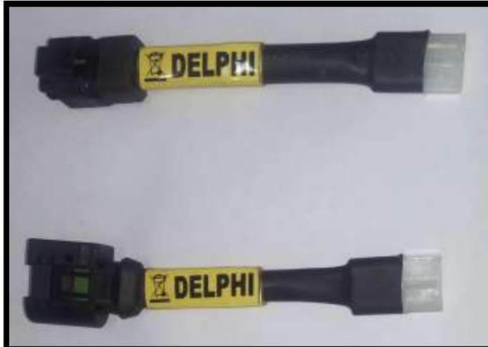
**Figura 12.** Simulador de sensor de presión en el riel Delphi
