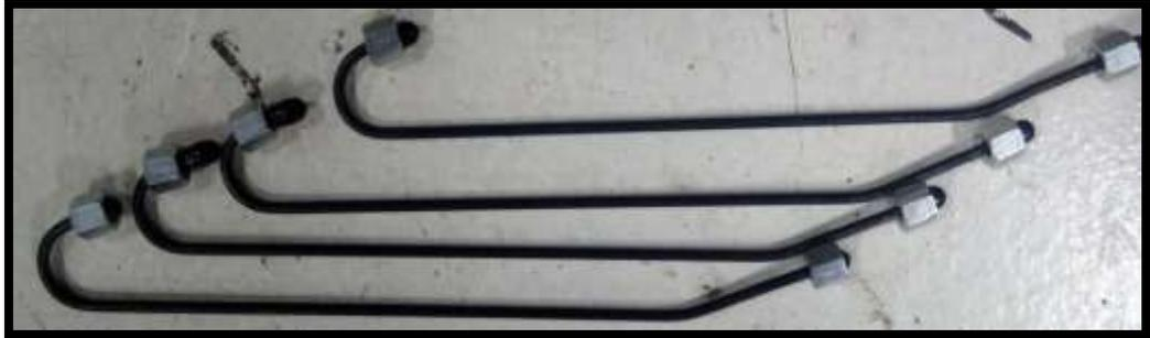
**Figura 15.** Extensión de tuberías para inyectores
