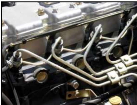
**Figura 2.** Tubería alta presión.
