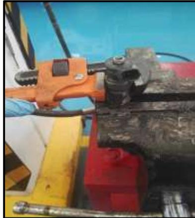
**Figura 36.** Despiece de bobina.
