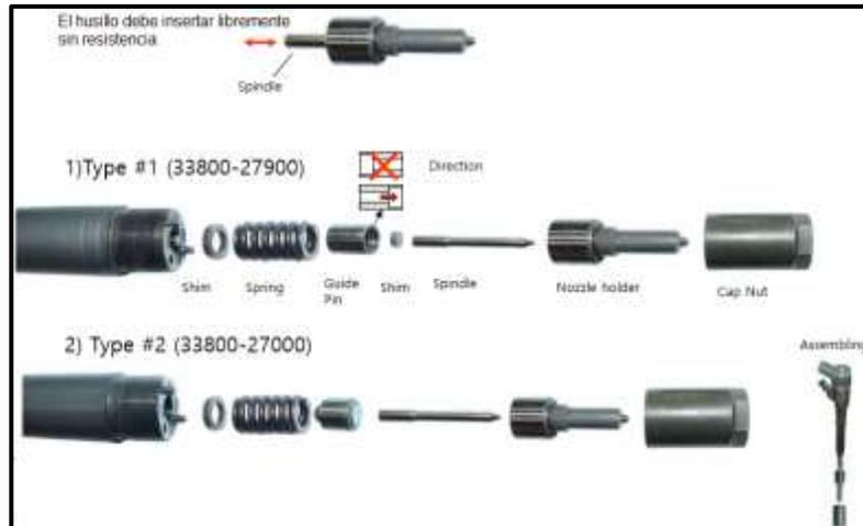
**Figura 42.** Partes del inyector.
