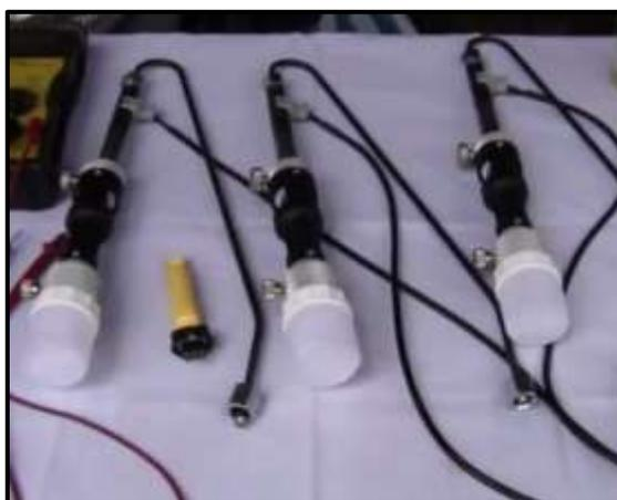
**Figura 22.** Extensión de inyectores.
