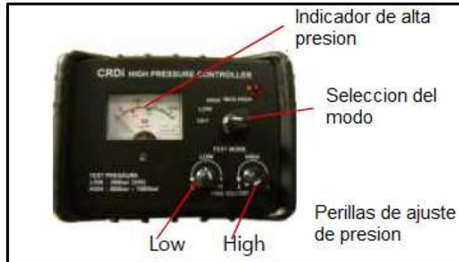
**Figura 27.** Ajuste de presiones.
