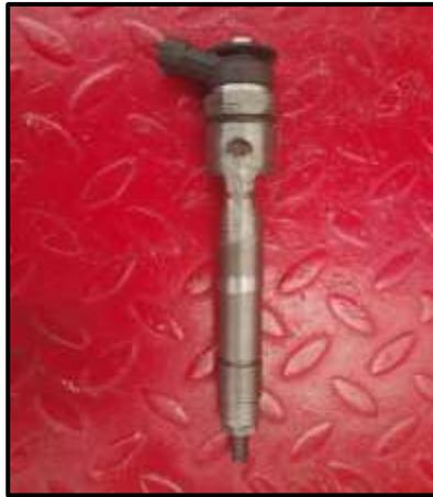
**Figura 34.** Inyector bosch CRDI.
