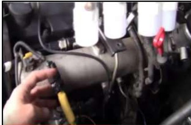
**Figura 18.** Emulador de sensor de presión de riel.
