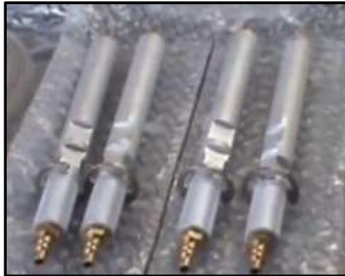
**Figura 20.** Acoples de prueba Delphi.
