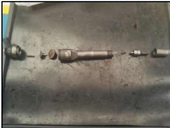
**Figura 37.** Partes de inyector Bosch CRDI.
