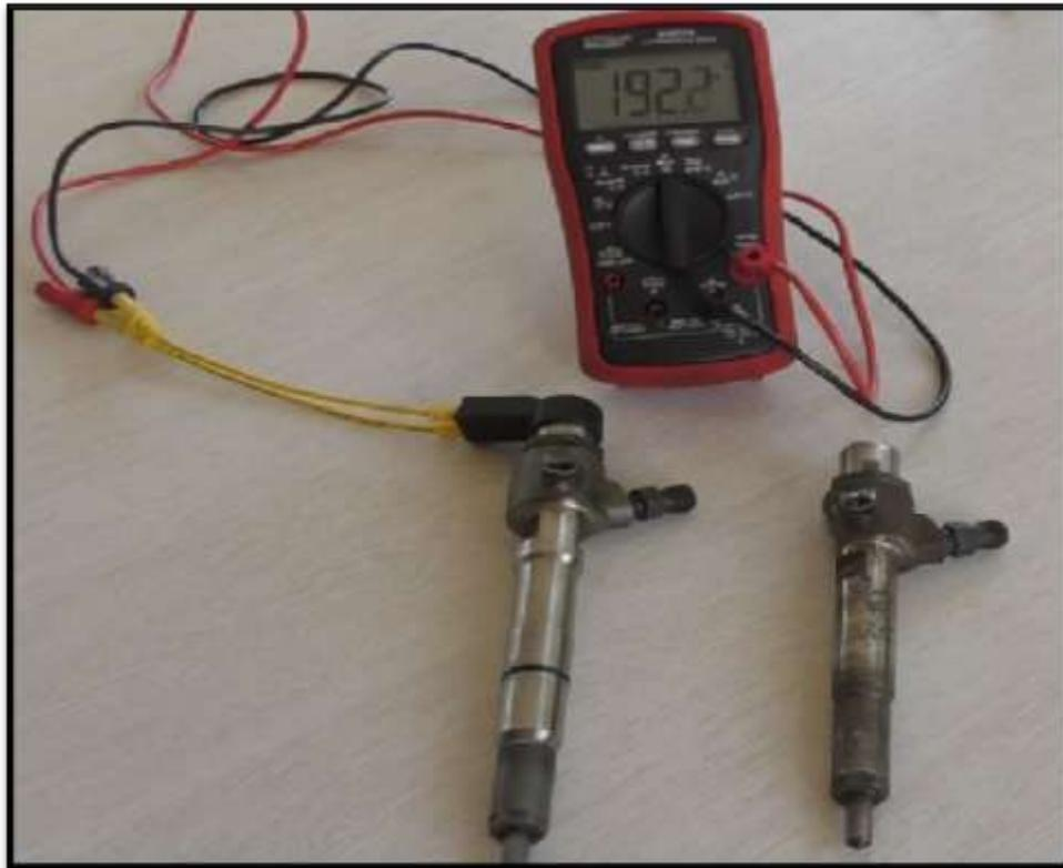
**Figura 27.** Revisión de resistencia de seguridad inyector piezoeléctrico.
