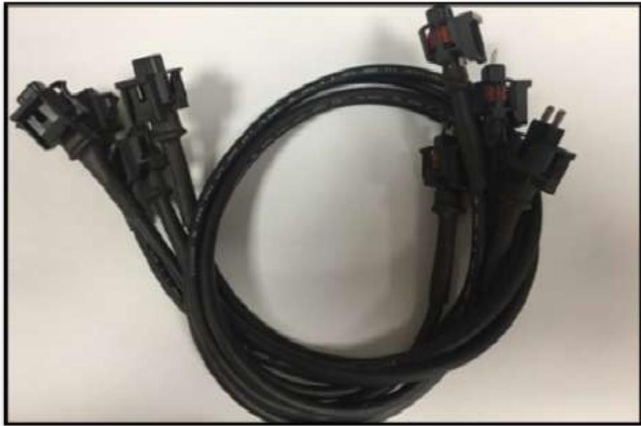
**Figura 18.** Extensiones de cables de inyector sistema Bosch.
