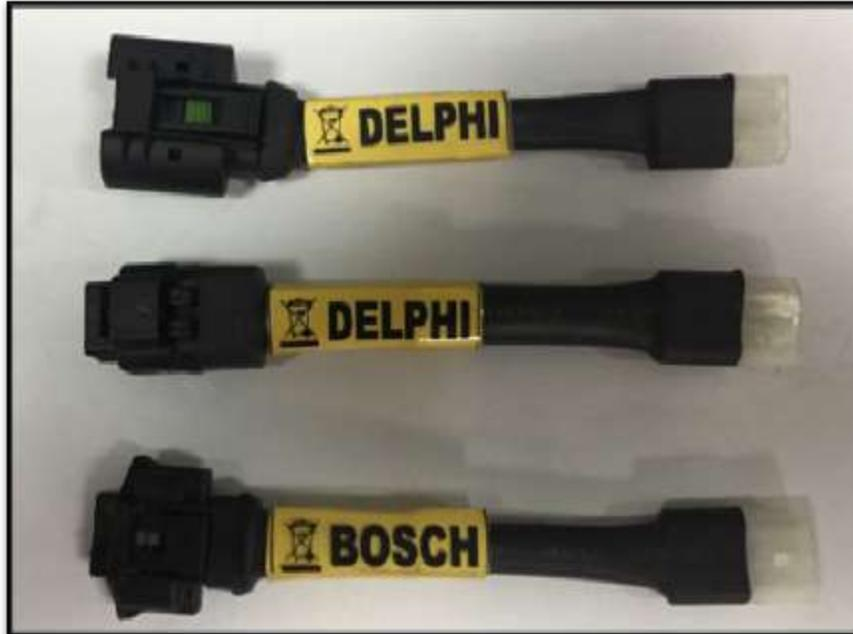
**Figura 22.** Conectores eléctricos para resistencias de simulación.
