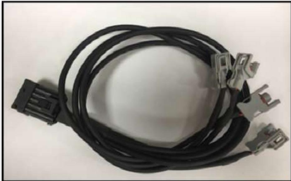
**Figura 19.** Extensiones de cables de inyector sistema Delphi.
