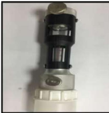
**Figura 26.** Probador de inyectores CRDI.
