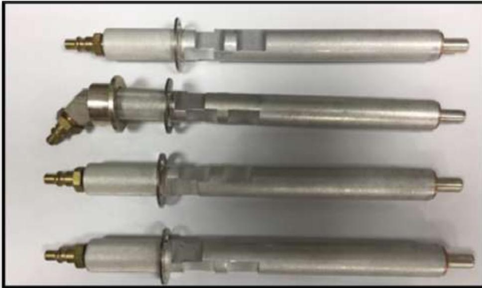
**Figura 25.** Acoples para medir compresión.
