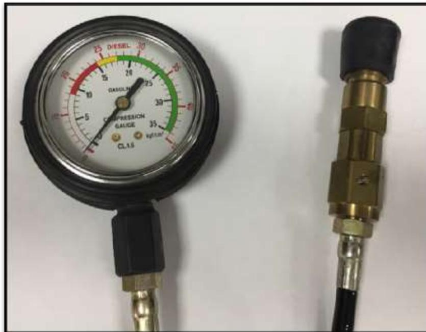
**Figura 17.** Manómetro para medir compresión.
