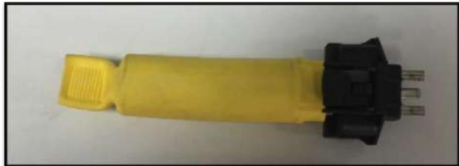
**Figura 24,** Resistencia de simulación de Sensor de presión del Riel.
