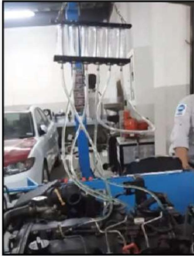
**Figura 29.** Prueba de retorno de combustible en motor J3 Hyundai.
