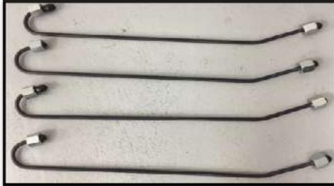
**Figura 20.** Extensiones de cañerías de alta presión.
