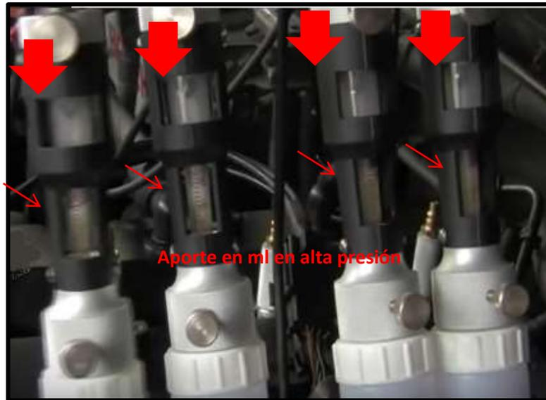
**Figura 45.** Análisis de alta presión en inyectores piezoeléctricos
