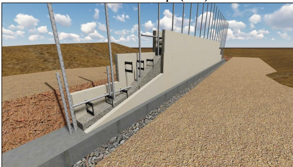
Ilustración 31: Colocación de Bloque (I.C.F) sobre cimiento
