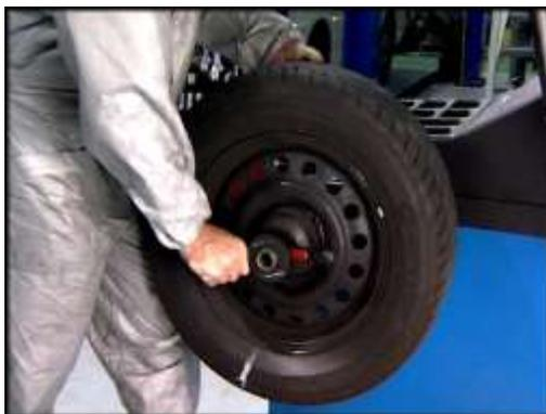
**Figura 26.**Neumático montado en la máquina de balanceo
