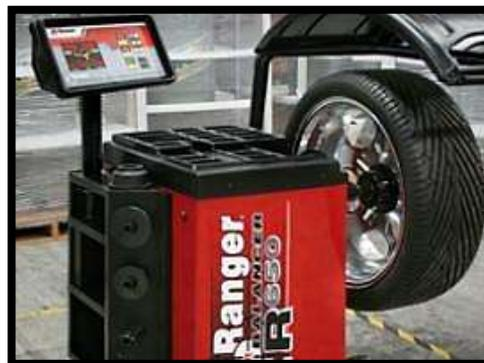
**Figura 31. Balanceando el neumático**
