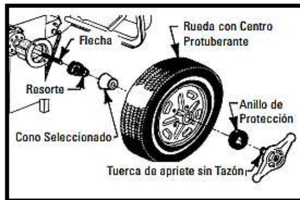
**Figura 25.**Montaje de rueda con centro protuberante
