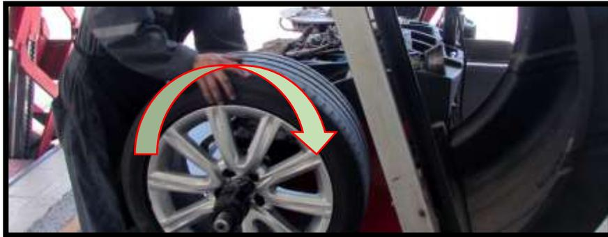
**Figura 28.**Neumático preparándose para revolución en máquina de balanceo
