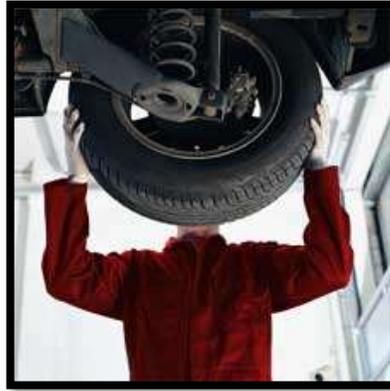
**Figura 32. Colocando el neumático en el vehículo**
