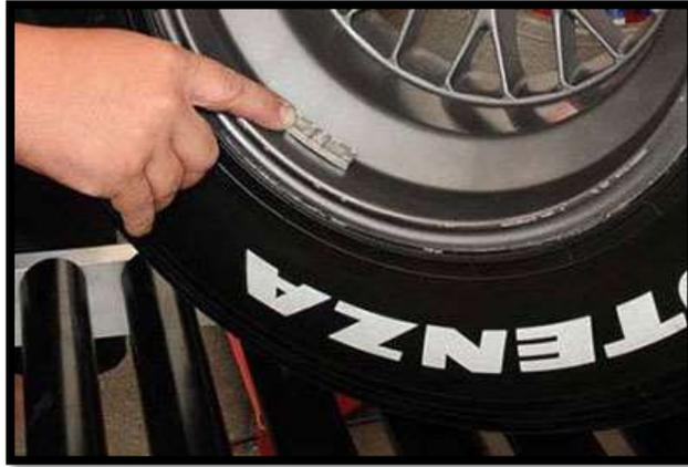
**Figura 30. Colocación de plomo**
