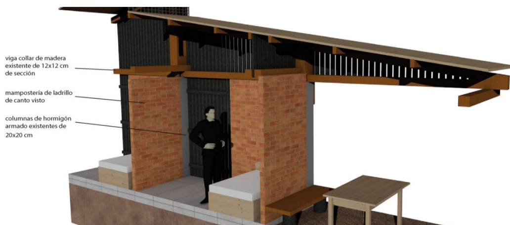
Imagen 49. Detalle de viga collar propuesta
