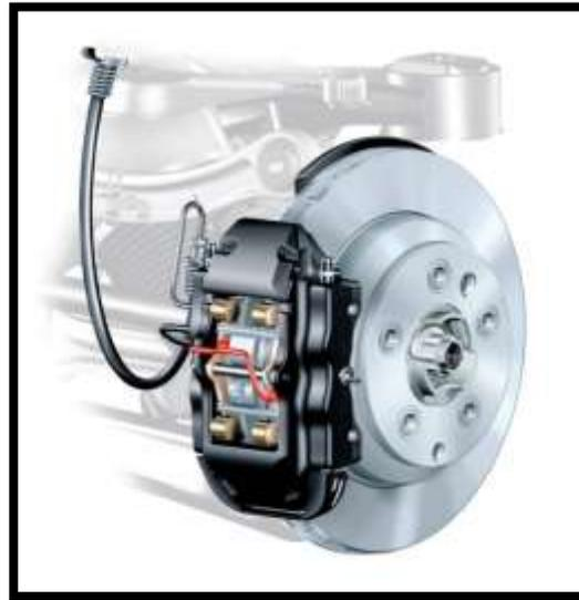
**Figura 10.** Fase 4 del sistema de frenado ABS
