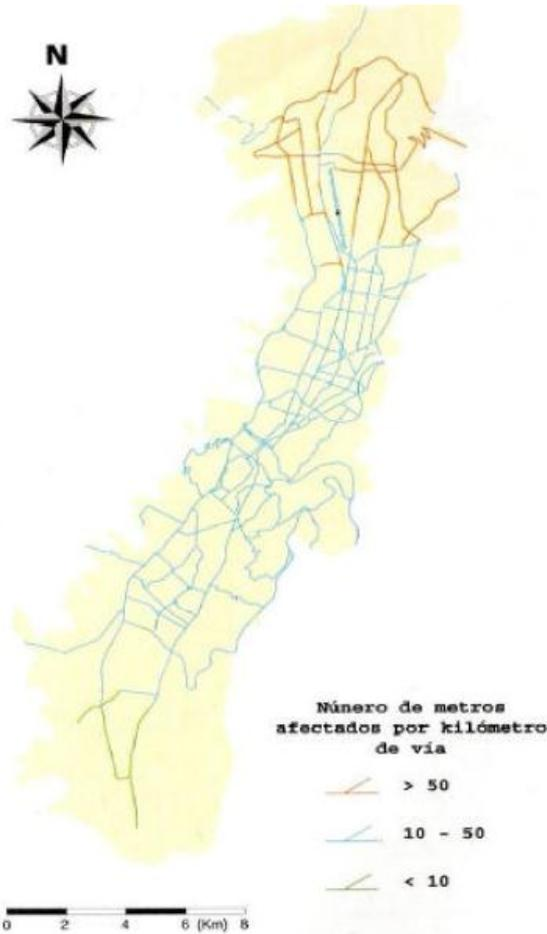
FIGURA I0. ESTIMACIÓN DE DAÑOS EN LA RED VIAL PRINCIPAL, PROVOCADOS POR UN POTENCIAL SISMO LOCAL.
