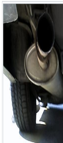
Tubo de escape unido al silenciador.
