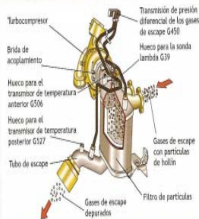
5.89. Esquema de limpieza de un FAP.
