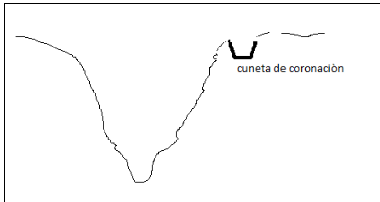
Figura 5: Cuneta de coronación Fuente: J. Lema
