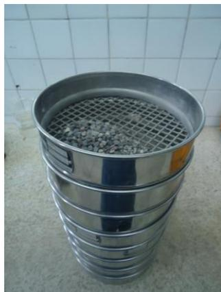
**FOTO N° 4** Ensayo de granulometría del agregado Grueso
