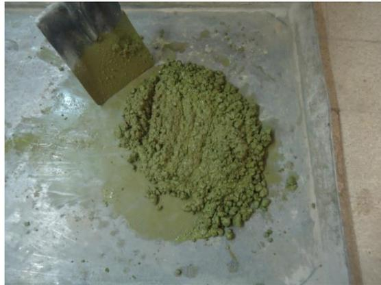
**FOTO N° 10** Medición del asentamiento en cilindros de prueba hormigón con pigmento fluorescente
