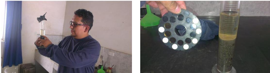
FOTO N° 3 Ensayo de granulometría del agregado Fino
