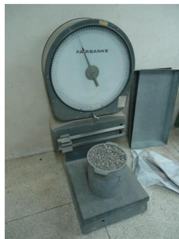
**FOTO N° 6** Ensayo de densidad aparente agregado fino compactado
