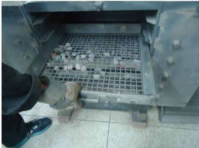
**FOTO N° 5** Ensayo de densidad aparente agregado grueso compactada
