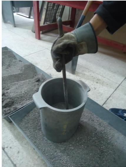
**FOTO N° 7** Medición del asentamiento en cilindros de prueba hormigón simple.
