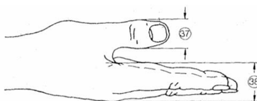
Figura 3. 8. Ancho del pulgar y grosor de mano según Norma DIN 33 402 2° parte.
