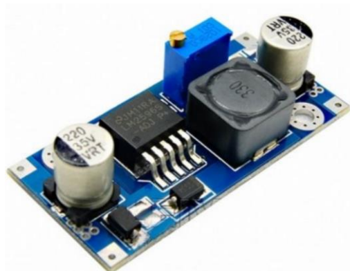
Figura 3. 36. Módulo conversor buck DC – DC LM2596-S, [51].
