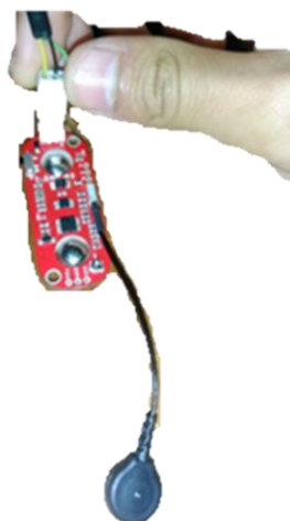
Figura 4. 12. Conexión del cable al sensor MyoWare.
