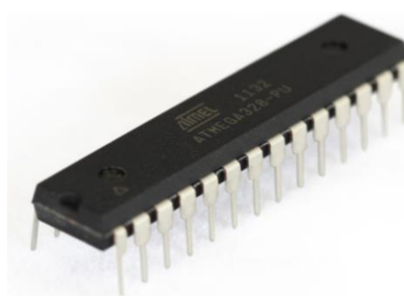
Figura 3. 33. Microcontrolador Atmega 328/PU, [48].
