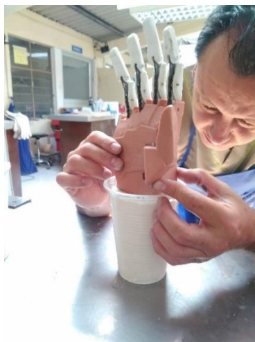
Figura 4. 16. Elaboración del molde para el cuerpo de la mano.
