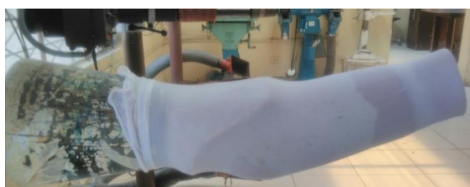
Figura 4. 23. Colocación de tela en el encaje.
