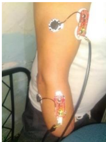
Figura 4. 14. Ubicación de los sensores MyoWare en el usuario.
