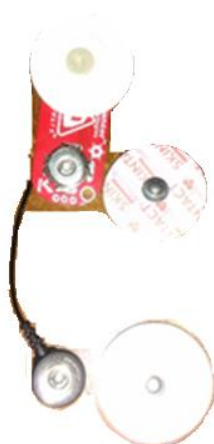
Figura 4. 13. Conexión de los electrodos a los sensores MyoWare.
