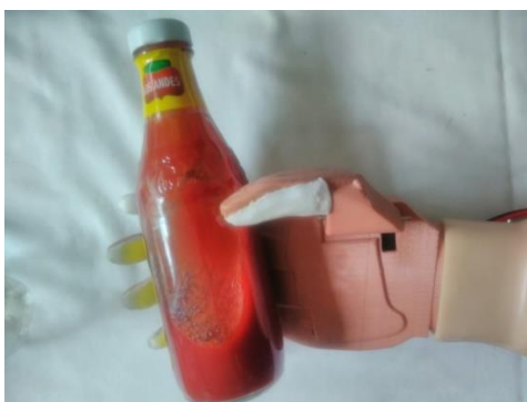
Figura 4. 32. Prueba de sujeción del máximo diámetro de agarre del prototipo.
