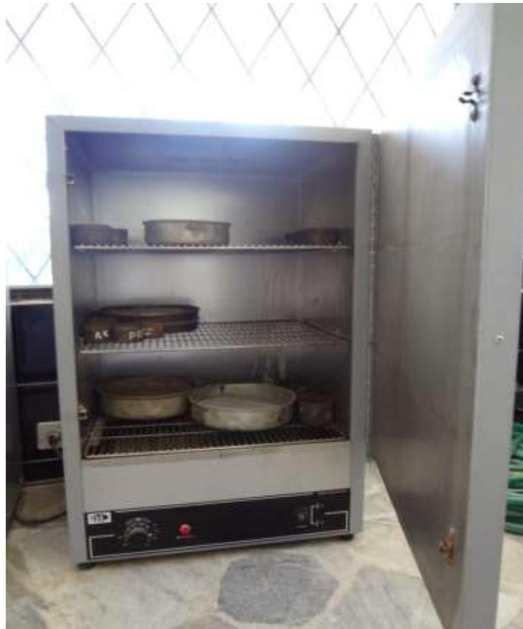
**Figura 7 Muestras de agregado para contenido de humedad**
