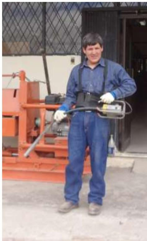
**Figura 17 Vibrador para hormigón**
