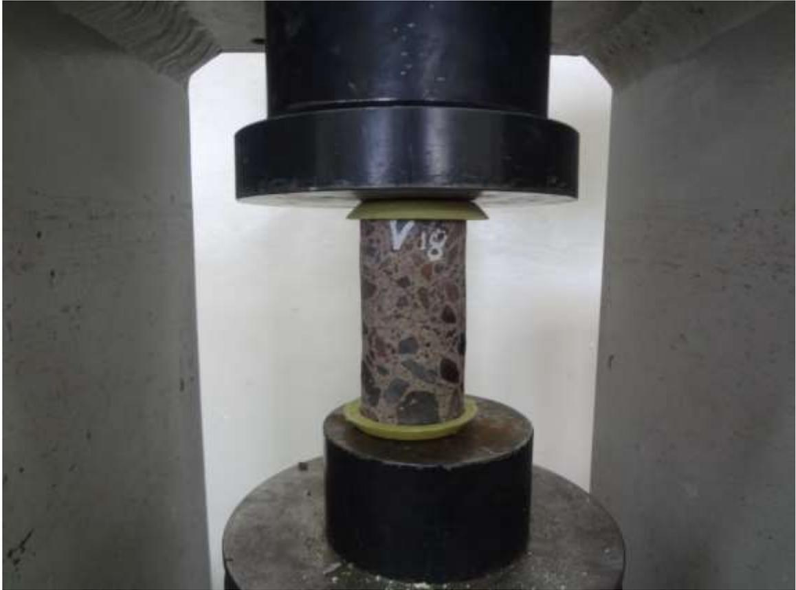
**Figura 29 Compresión de núcleos de hormigón**
