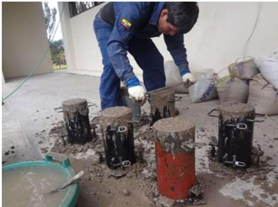
**Figura 20 Enrasado de cilindros**
