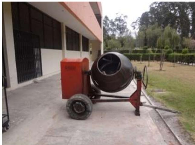
**Figura 11 Concretera de un saco de capacidad**
