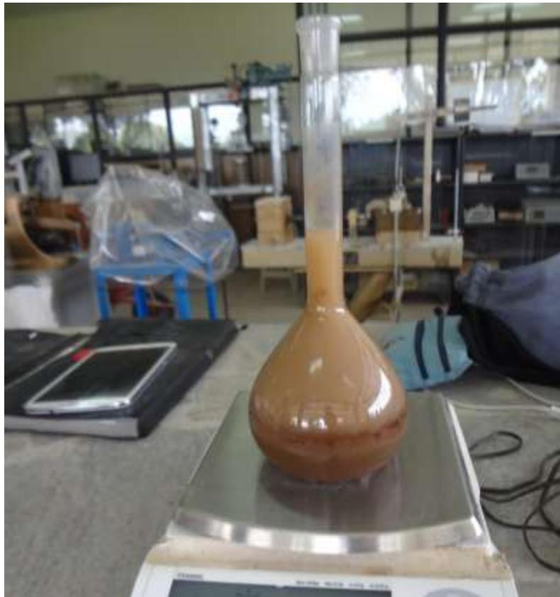
**Peso específico agregado fino**
