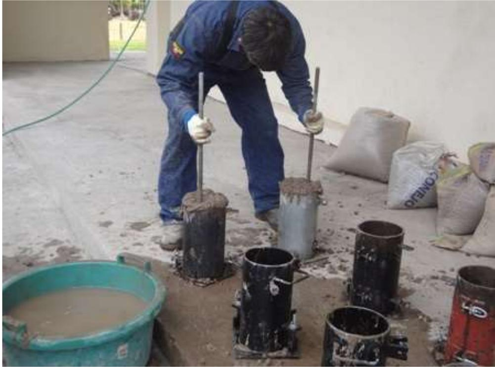
**Figura 19 Varillado de en la fabricación de cilindros**
