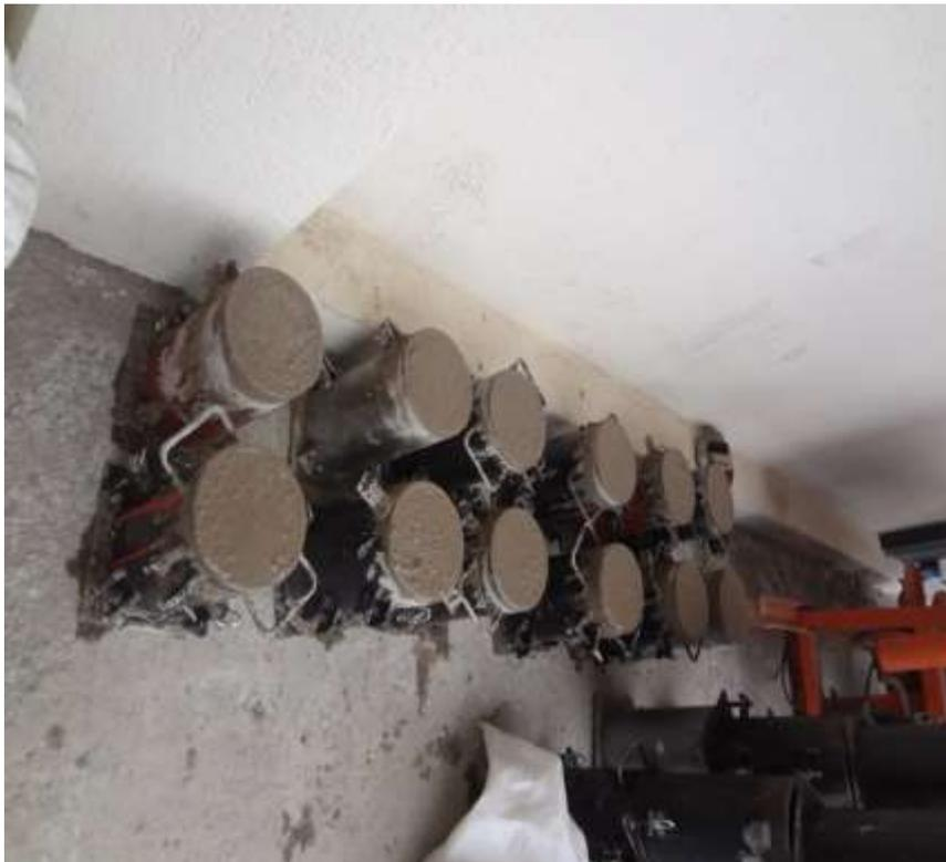
**Cilindros de hormigón terminados**
