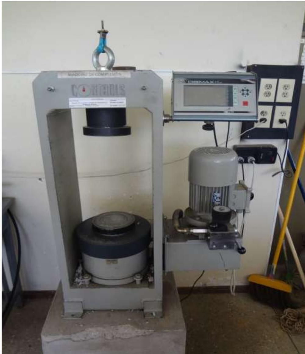
**Figura 22 Máquina de compresión simple 2000 kN**
