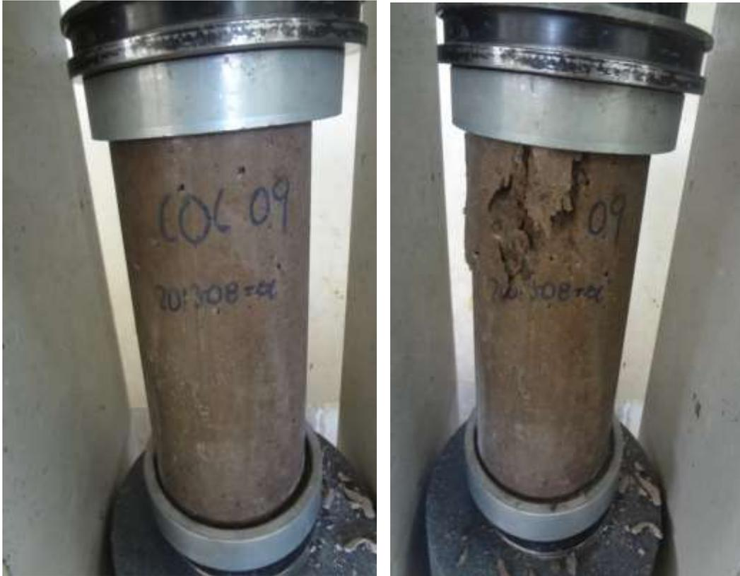
**Figura 23 Ensayo de compresión de cilindros de hormigón**
