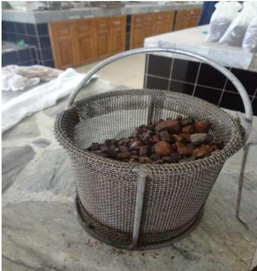
**Peso específico agregado grueso**
