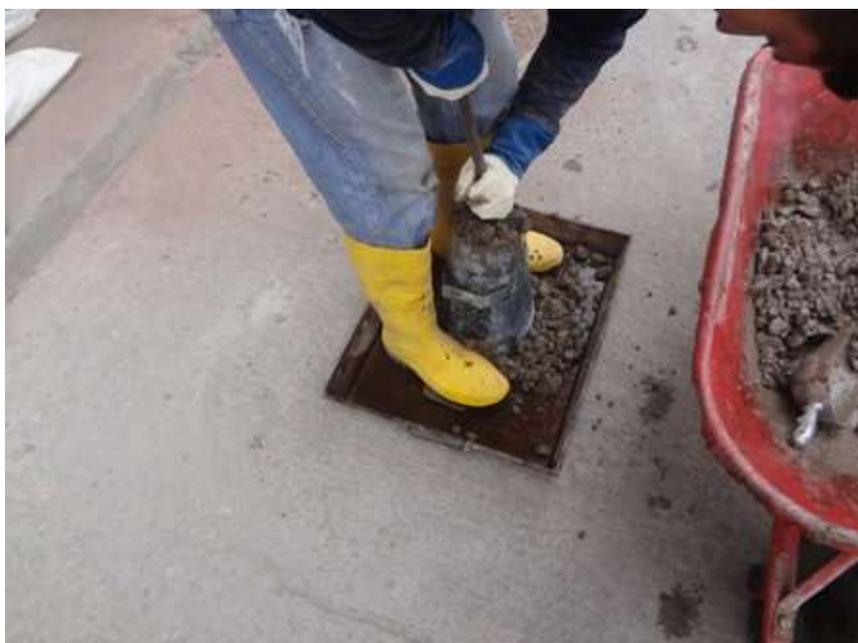
**Figura 18 Determinación del revenimiento de la mezcla**
