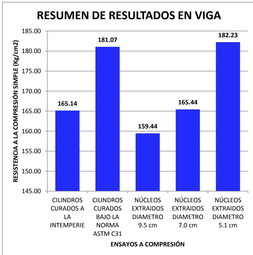
Se presenta a continuación el gráfico 7 de resumen de los cilindros y núcleos ensayados a los 28 días de edad en el cual se nota los valores máximos de resistencia de la viga.
