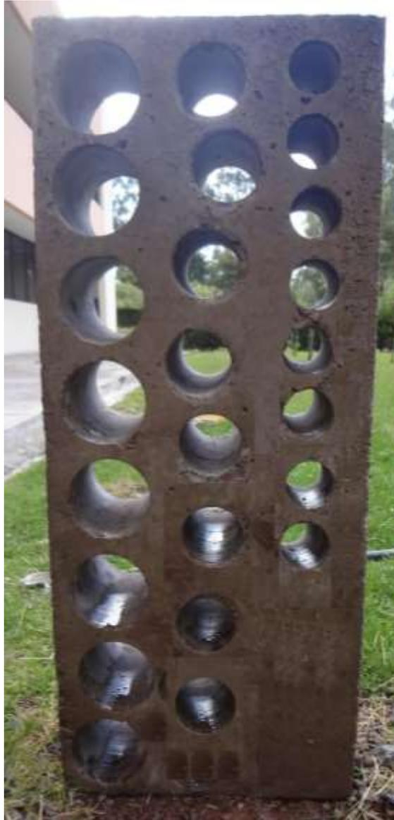
**Figura 28 Extracción de núcleos en columna**
