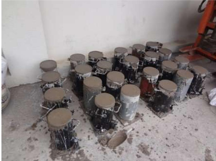
**Figura 21 Cilindro terminado**
