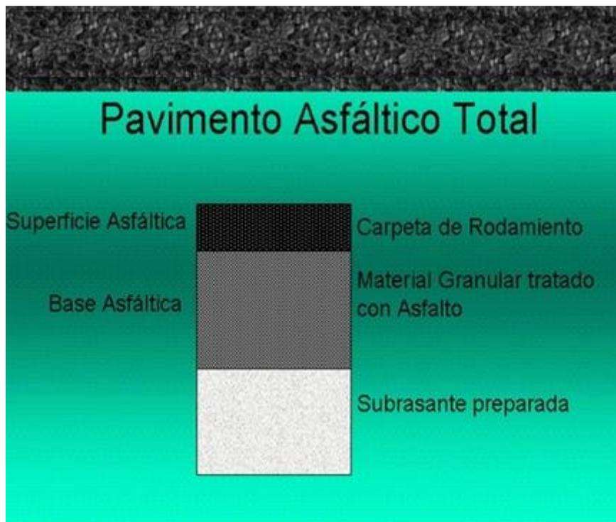
Figura. 2.5. Pavimentos flexibles, secciones transversales
