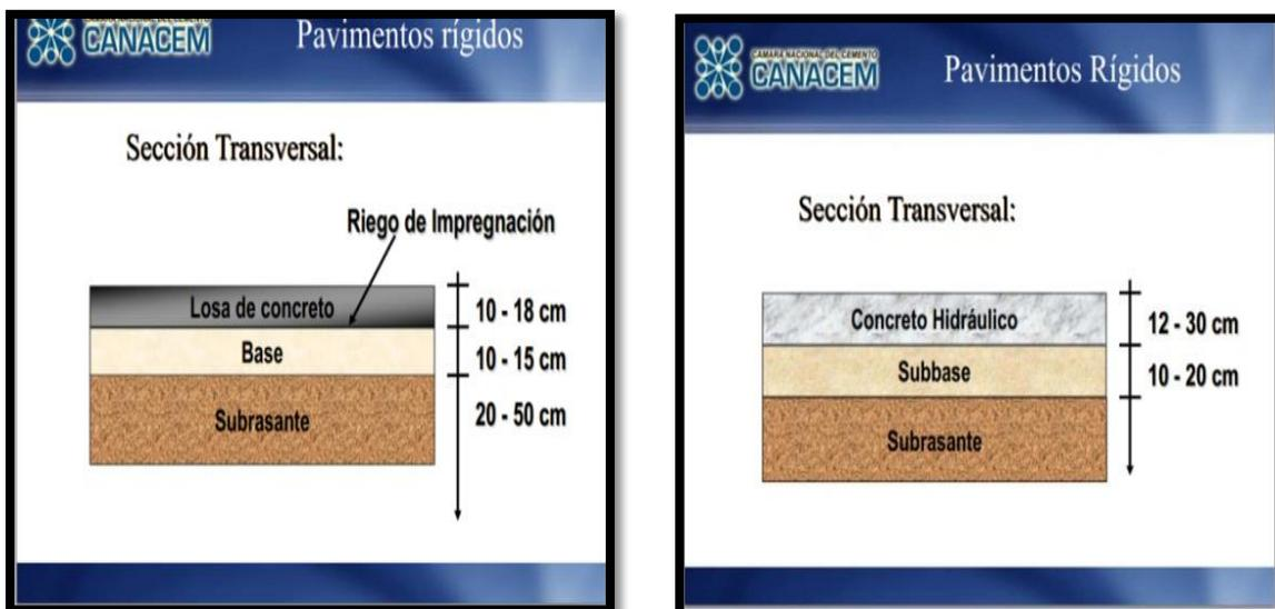
**Figura. 2.7. Pavimentos Rígidos, secciones transversales**
