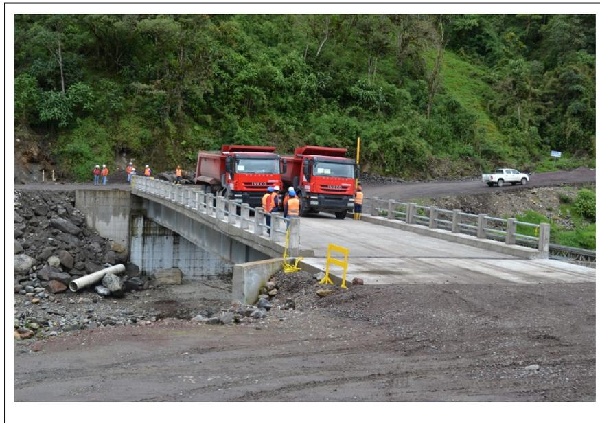
**Gráfico 4.19:** Pruebas de Carga, utilizando la carga de diseño de 43,5 Ton en el centro del Puente durante 1 hora. Se verifican las deflexiones permitidas de acuerdo al Diseño.
