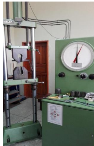
Figura 42 Ensayo de tracción del bronce
