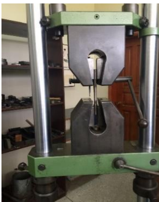
Figura 59 Ensayo de tracción del acero
