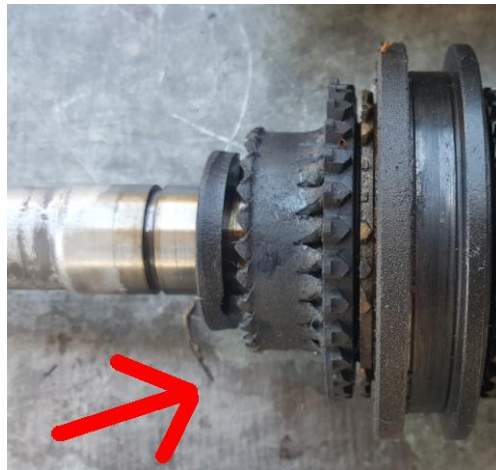
Figura 1.17 Desgaste de piñón
