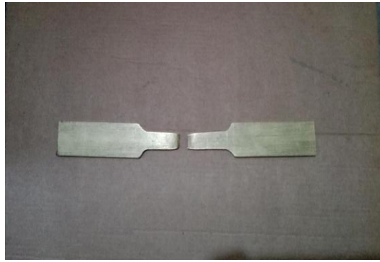
Figura 44 Ruptura de material
