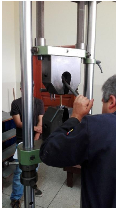
Figura 43 Ensayo de tracción del bronce
