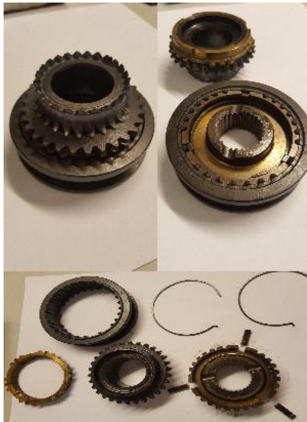
Figura 36 Partes del sincronizador
