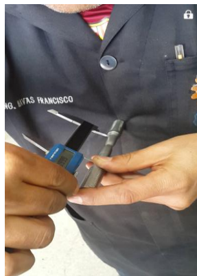
Figura 3.29 Medición entre marcas
