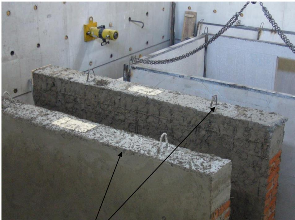
Fig. 4.1 Vigas de transmisión de carga ancladas a la mampostería
