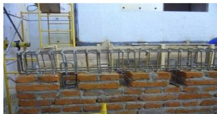
Fig. 4.8 Unión Viga-Mampostería.
