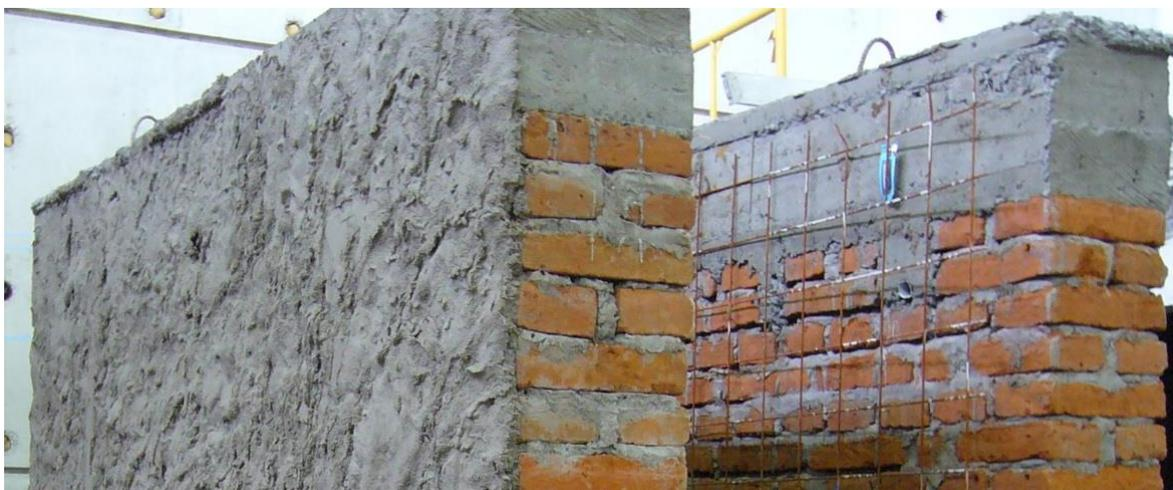
Fig. 4.9 Vista lateral unión malla a pared y viga
