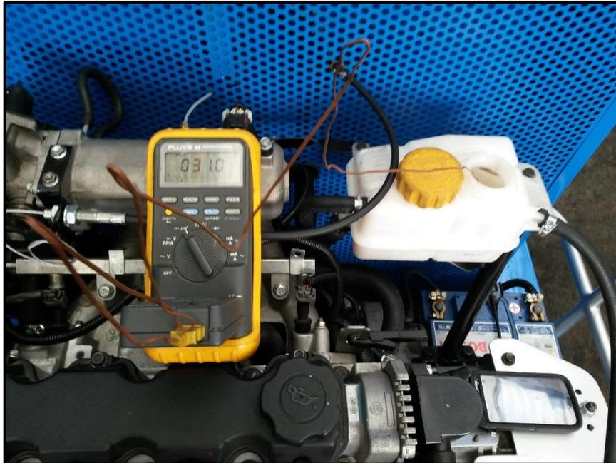
**FIGURA 57: Temperatura del refrigerante sin simulación 31°C**
