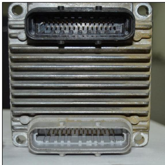
**FIGURA 22: Unidad de control electrónico (ECU)**
