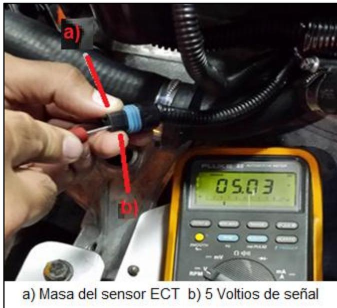
**a) Masa del sensor ECT b) 5 Voltios de señal**
