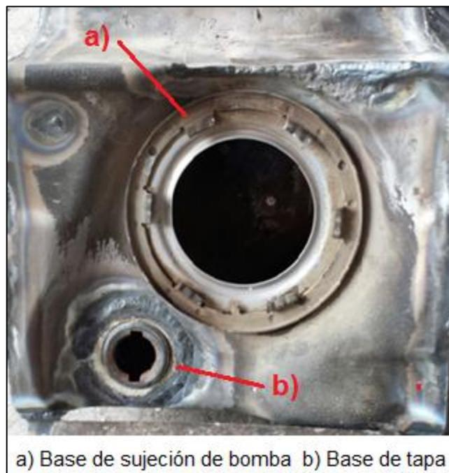
**FIGURA 38: Tanque de Combustible**
