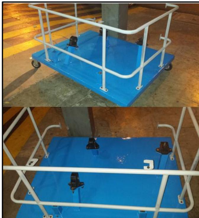
**FIGURA 45: Acabado de pintura de la estructura base**
