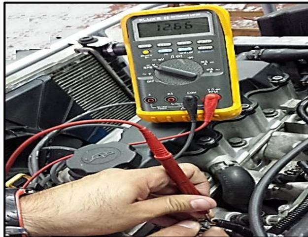
**FIGURA 122: Voltaje de alimentación de inyector**
