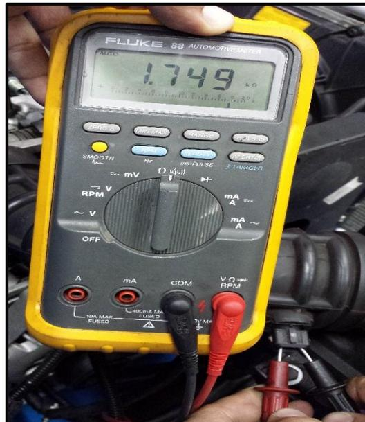
**FIGURA 72: Resistencia del sensor IAT a 29 °C**
