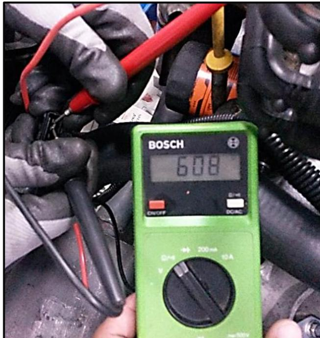
**FIGURA 111: Resistencia del sensor CKP**
