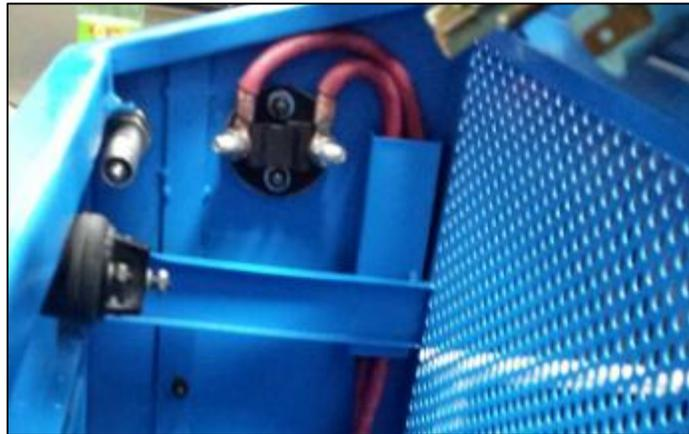
FIGURA 42: Conexión de switch de corte de energía
