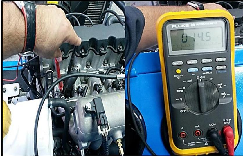
**FIGURA 121: Valor de resistencia de un inyector**
