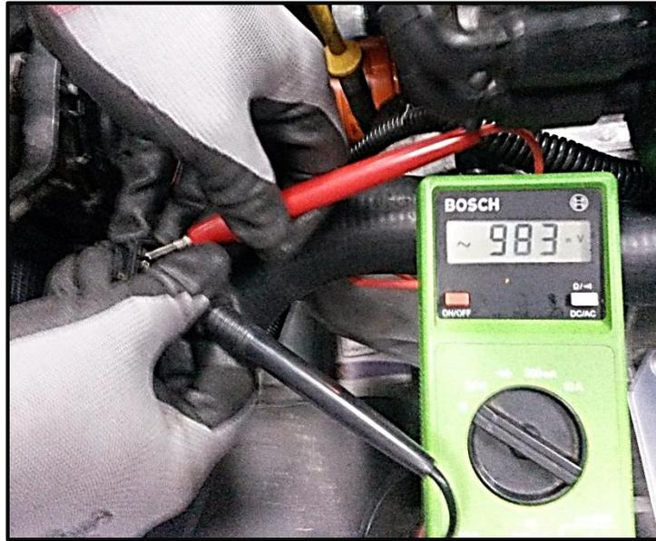
**FIGURA 110: Voltaje de CA generado en arranque**
