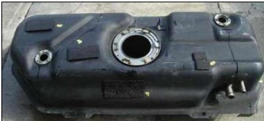
**FIGURA 37: Tanque de Combustible original**
