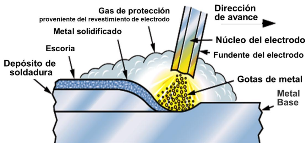
Figura 97 Proceso de soldadura
