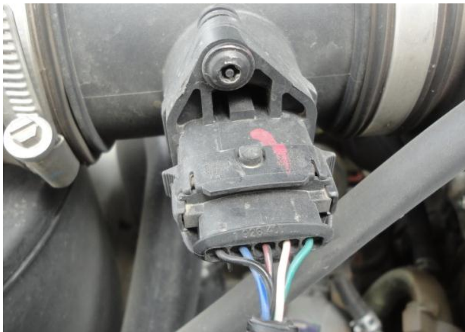
Figura 16 Sensor IAT y MAF de la D-Max 3.0
