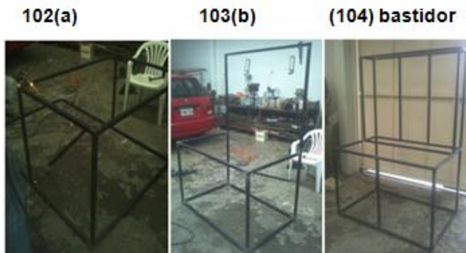
Figura 91 Construcción del bastidor
