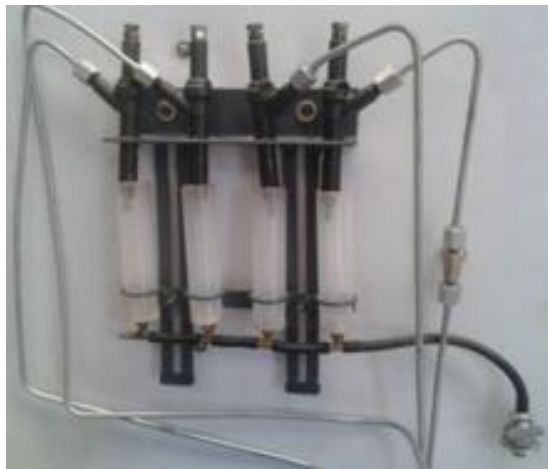
Figura 103 Línea de alta presión
