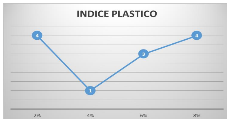
Grafico 11: Comportamiento del índice plástico a diferentes porcentajes de cemento. Fuente: Erick Gavilanes Bayas.
