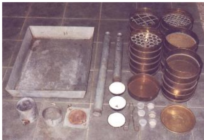
Figura 11: Juegos de tamices para ensayo de granulometría. Fuente: UPS Universidad Politécnica Salesiana.
