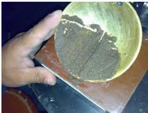
Figura 13: Limite Liquido en copa Casagrande. Fuente: UPS Universidad Politécnica Salesiana.
