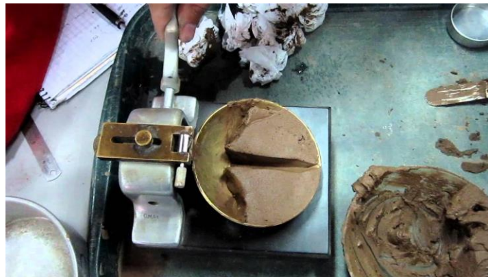
Figura 30.- Ensayo para determinar el límite líquido del suelos mediante la copa de Casagrande . LABORATORIO ZITROCI
