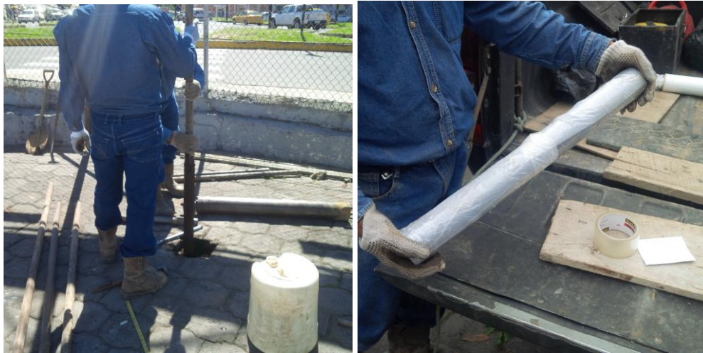
Figura 25.- Toma de muestra inalterada tipo shelby y sellado . EMS ZITROCI-2014
