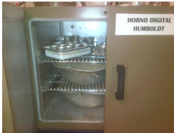
Figura 28.- Secado en horno de muestras para determinación de contenido de humedad del suelo. LABORATORIO ZITROCI
