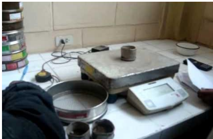
Figura 29.- Medición del peso de muestra seca en la balanza digital. LABORATORIO ZITROCI.
