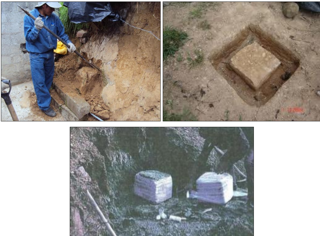
FIGURA 26.- Toma de muestra inalterada tipo bloque EMS ZITROCI-2012
