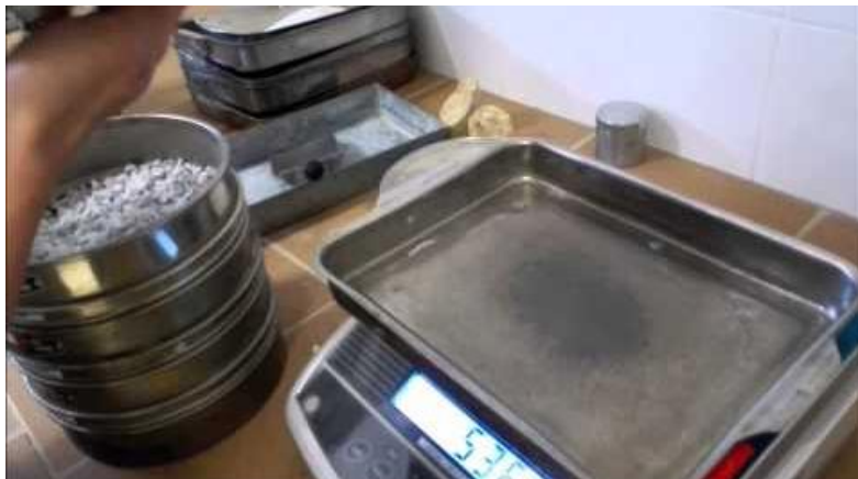
Figura 34.- Ensayo de granulometría proceso de medición de peso por tamiz. LABORATORIO - ZITROCI.
