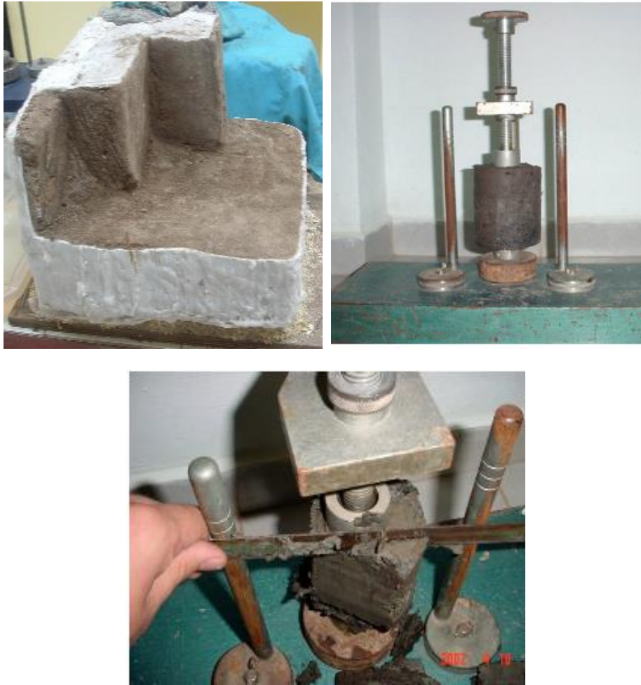
Figura 44.- Tallado de muestras para obtención de probetas de ensayo – LABORATORIO - ZITROCI
