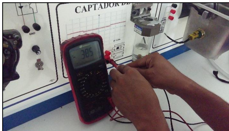
Figura 100. Mediciones del captador de agua
