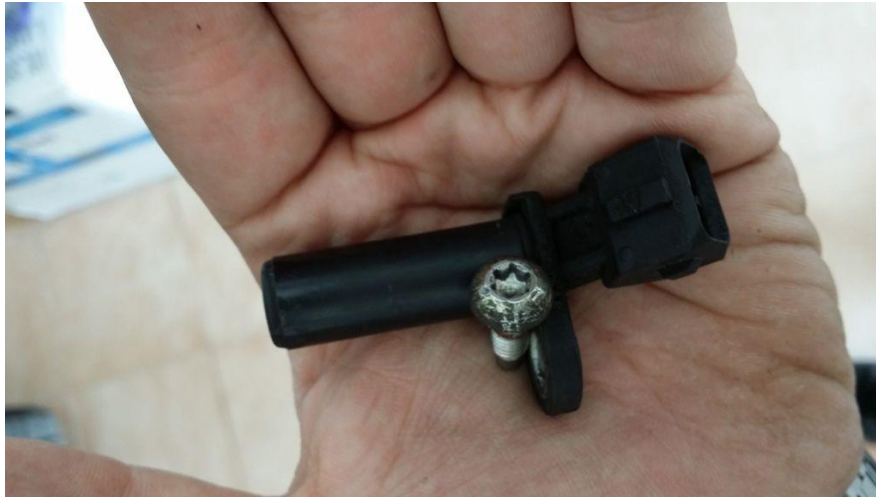
Sensor CKP del motor RQB (Referencia: Ford 948F 6C 31 SAA)
