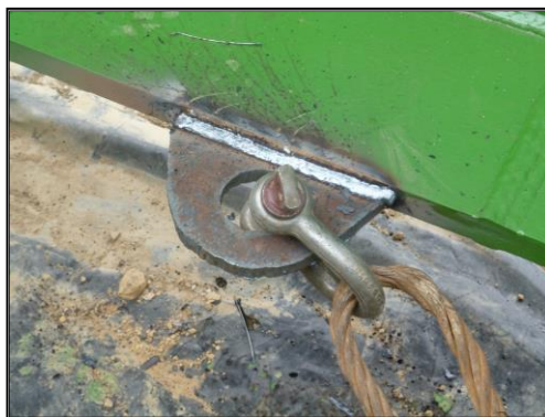
Ilustración 21.- Soldado de orejas para sujeción
