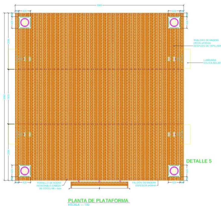
Ilustración N° 18.- Modulo tipo para Muelle-Pasarela Flotante
