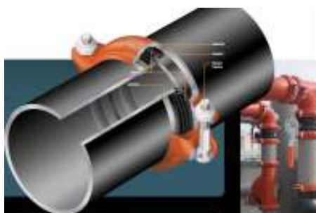
Figura No.28 Esquema de montaje de tubería
