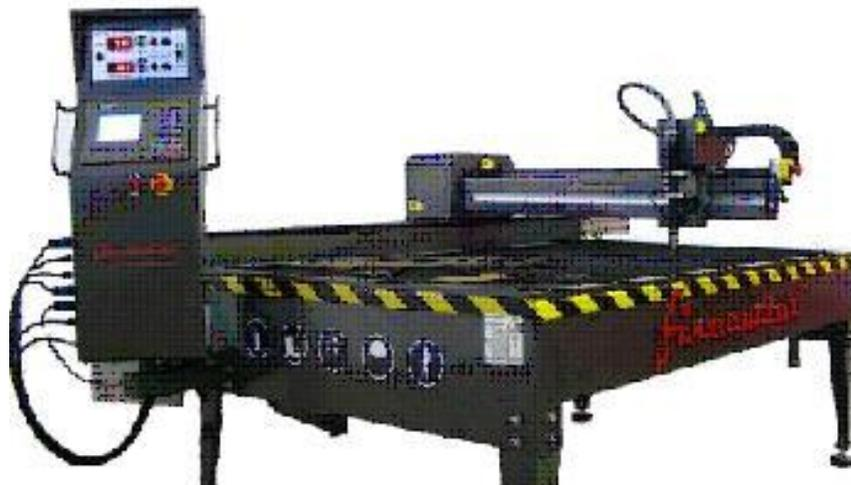
**Figura 4.4.:** Equipo automático de oxicorte
