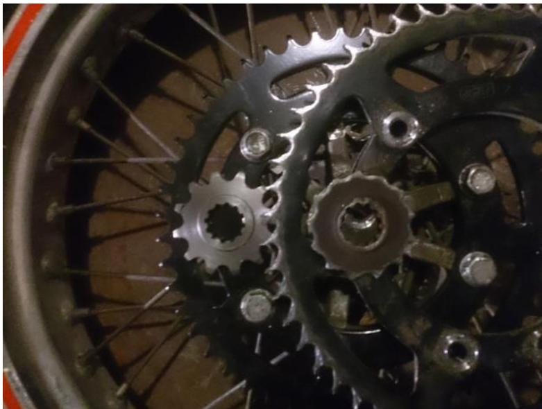
**Figura 2.9.:** Comparación desgaste de piñones por excesiva tensión en cadena
