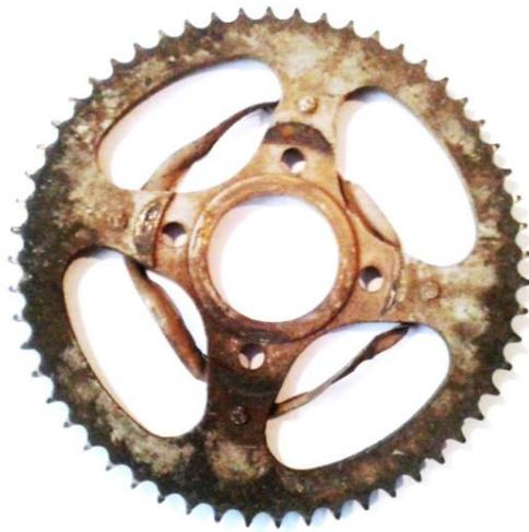
**Figura 3.1.:** Figura catalina 56 dientes, muestra física
