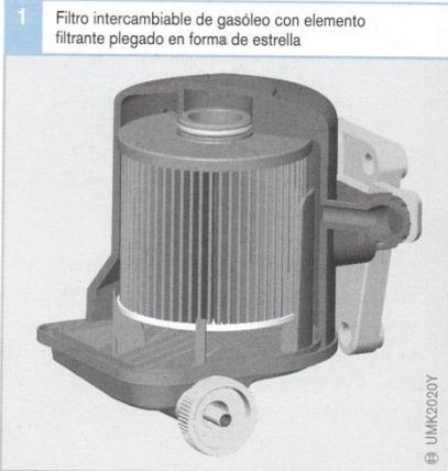
Está ampliamente extendida la utilización de filtros intercambiables enroscables, filtros "Inline" y elementos filtrantes no metálicos como piezas intercambiables alojadas en la carcasa del filtro hecha de aluminio, de plástico integral o de chapa de acero (para satisfacer los requisitos más exigentes en materia de protección en caso de choque). En dichos filtros sólo se sustituye el elemento filtrante. Se utilizan preferentemente elementos filtrantes plegados en forma de estrella (figura 1).
