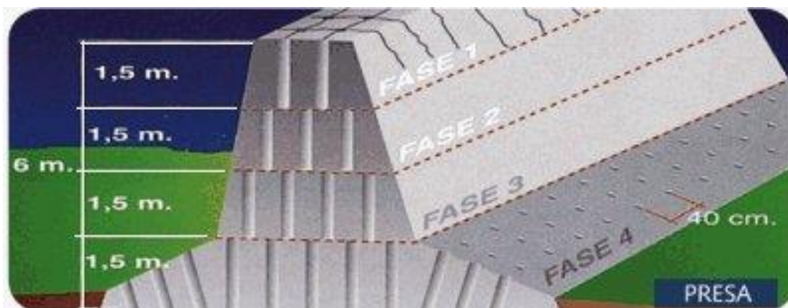
Fig. 9 Corte de vertical de hormigón.
