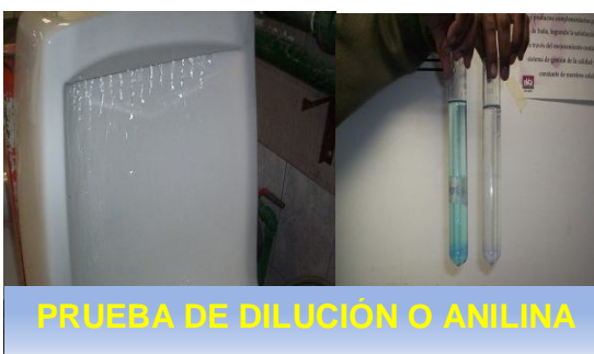
Figura 30. Prueba de dilución o anilina Fuente: EDESA
