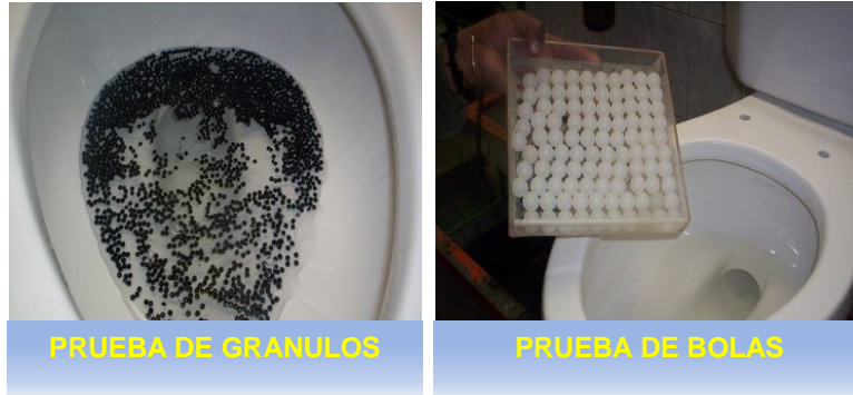
Figura 25. Prueba de gránulos y bolas
