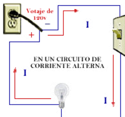
FIGURA 1.2 CIRCUITO DE CORRIENTE ALTERNA
