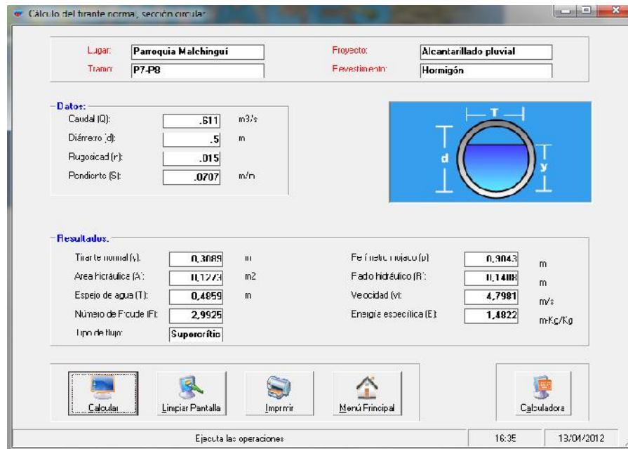
Ilustración 19. Corrida de comprobación del tirante normal, en sección circular en H Canales para tramos intermedios.
