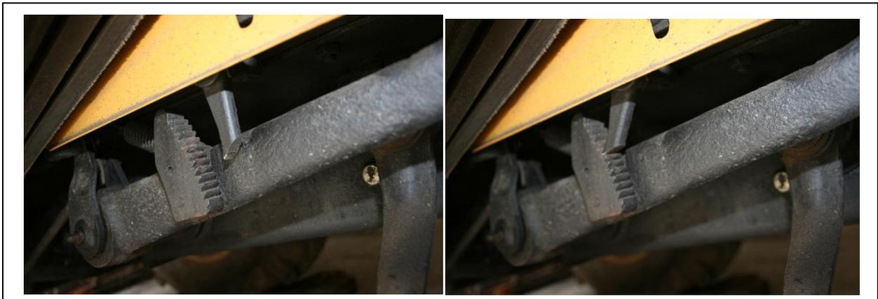
**Figura 2.26.** Freno de seguridad acoplado y desacoplado
