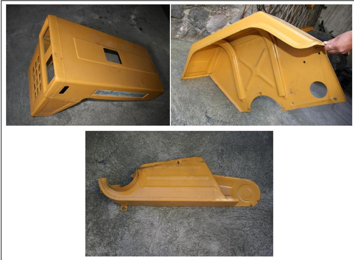
**Figura 2.8.** Partes de la Carrocería
