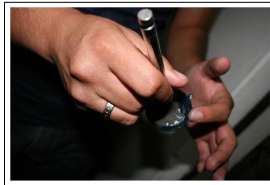
**Figura 2.16.** Asentamiento de válvulas
