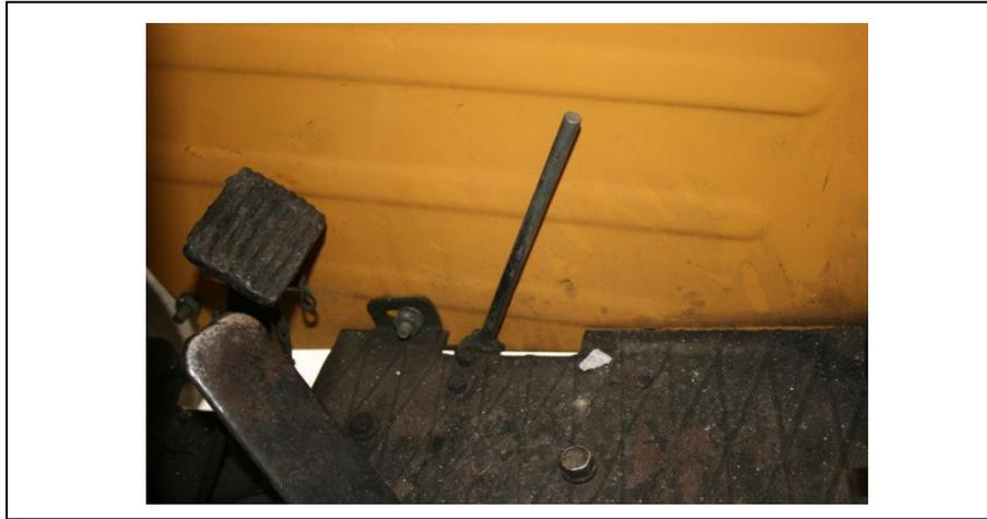
**Figura 2.27.** Palanca de accionamiento de freno de estacionamiento
