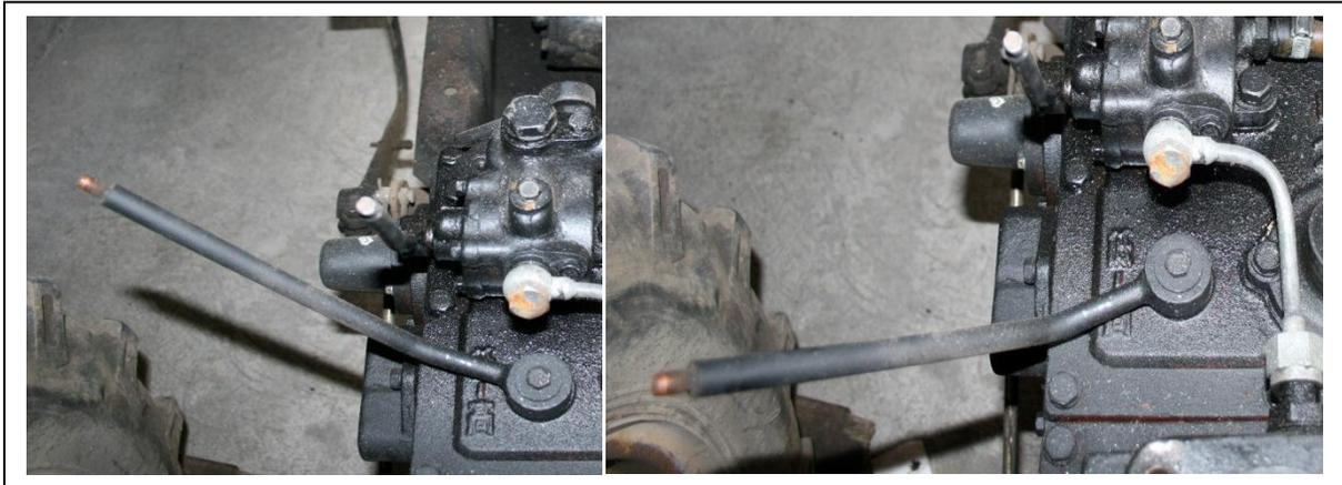
**Figura 2.22.** Palanca de reducción y aumento
