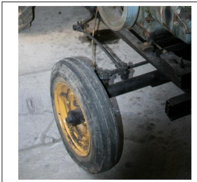
**Figura 2.30.** Barra de dirección y eje de giro
