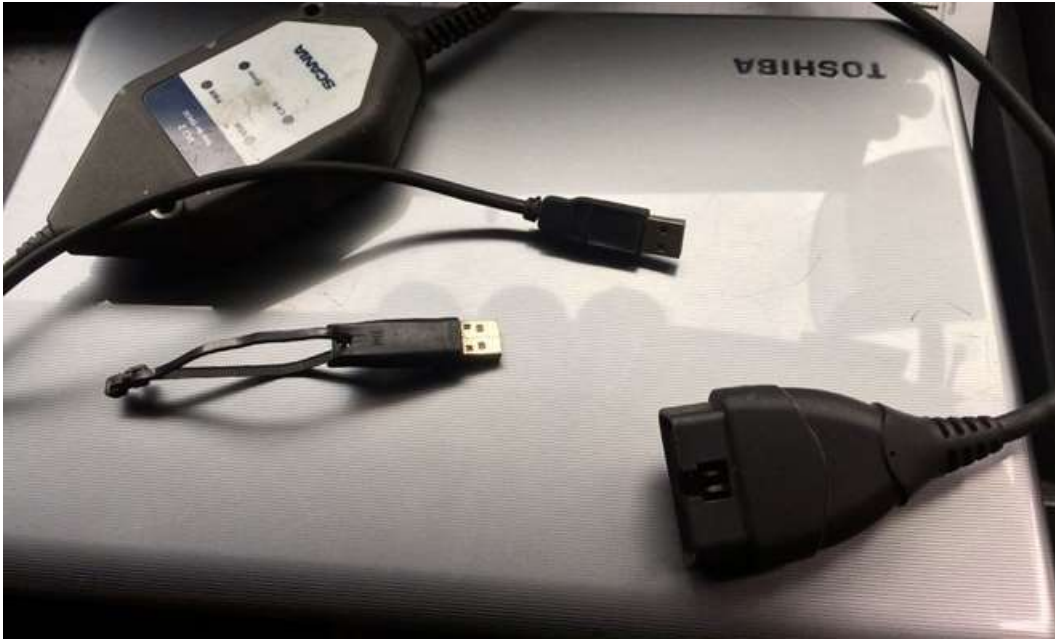
Figura 37 Laptop con software SDP3 Y VCI, con llave de USB de activación
