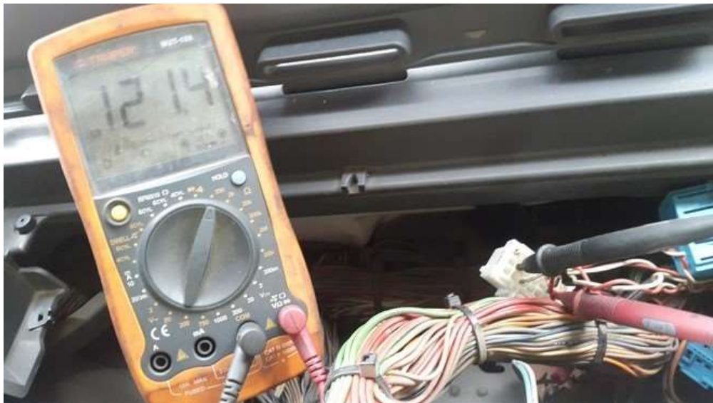
Figura 23 Medición de resistencia en el conector C480 Fuente. Daniel Murillo
