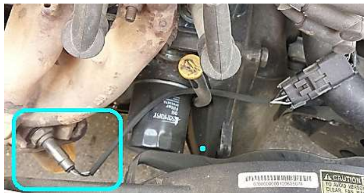
Figura 23. Ubicación del Sensor de oxígeno del Chevrolet Corsa Wind 1.4 L Editado por: Luis Cáceres
