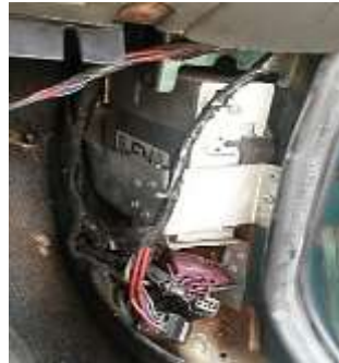
Figura 12. Ubicación del módulo de control electrónico Chevrolet Corsa Wind 1.4L Editado por: Luis Cáceres
