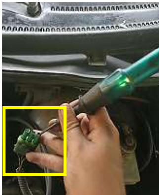
Figura 40. Comprobación de la línea de masa del sensor Editado por: Luis Cáceres
