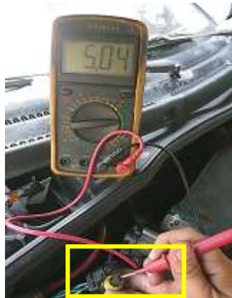
Figura 31. Medición del voltaje de alimentación en el sensor TPS Editado por: Luis Cáceres
