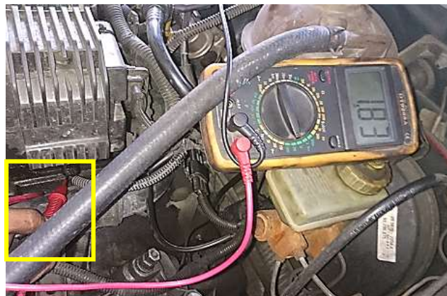
Figura 35. Medición de la línea de señal del sensor ECT Editado por: Luis Cáceres
