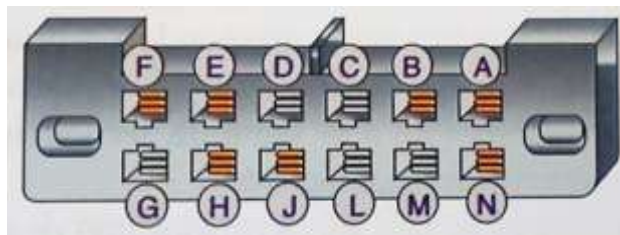
Figura 5. Descripción de los pines de la interface ALDL
