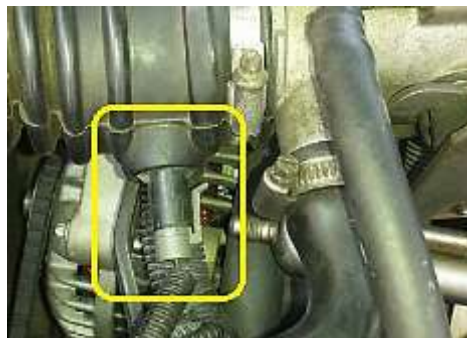
Figura 19. Sensor IAT del Chevrolet Corsa Wind 1.4 L Editado por: Luis Cáceres
