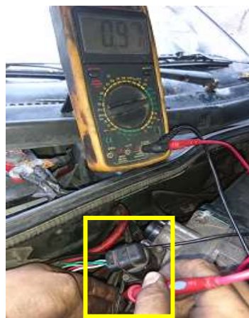
Figura 33. Medición de la línea de señal del sensor TPS
