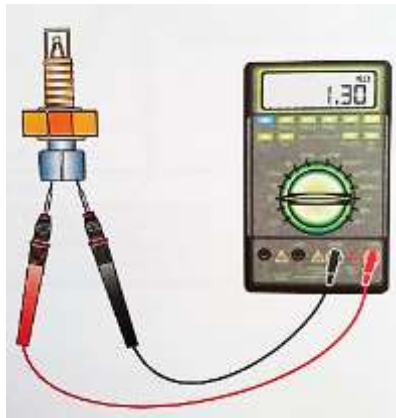
Figura 44. Medición de la resistencia interna del sensor IAT
