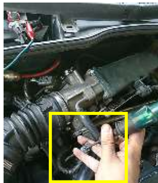
Figura 42. Comprobación de la línea de masa del sensor IAT Editado por: Luis Cáceres
