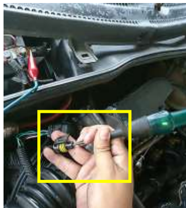
Figura 32. Comprobación de la línea de masa en el sensor TPS Editado por: Luis Cáceres
