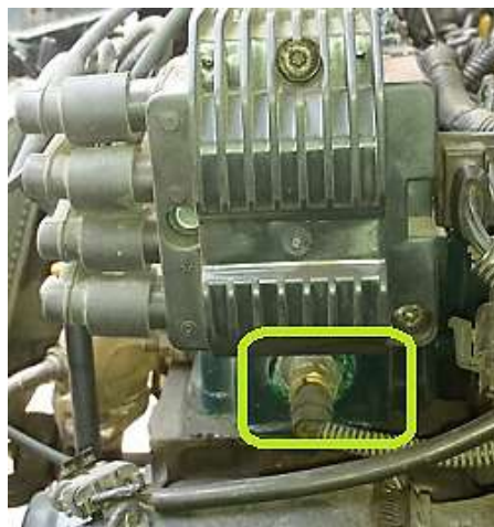
Figura 21. Ubicación del Sensor ECT del Chevrolet Corsa Wind 1.4 L Editado por: Luis Cáceres
