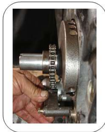
Gráfico 3.51 Ajuste del mecanismo tensor
