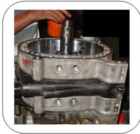
Gráfico 3.40 Instalación de la tapa intermedia y estator posterior
