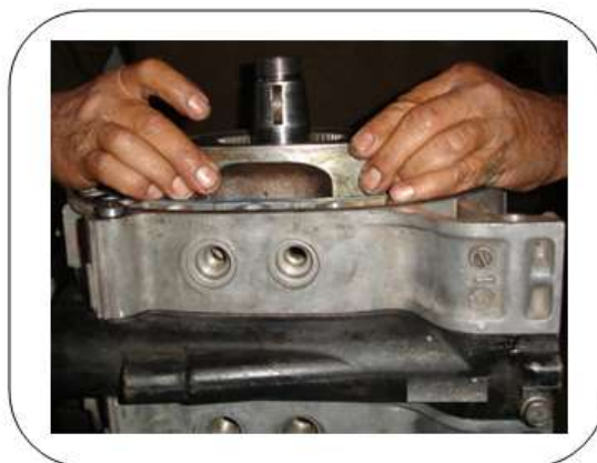
Gráfico 3.41 Introducción del rotor posterior
