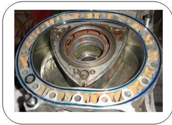
Gráfico 3.38 Instalación del rotor primario
