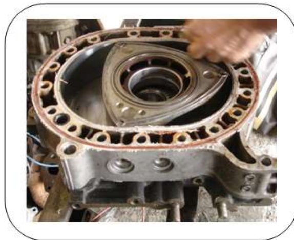
Gráfico 3.26 Desmontaje rotor y estator frontal
