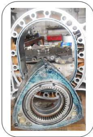
Gráfico 5.20 Exceso de grasa en el estator periférico y una cara del rotor
