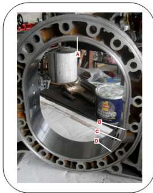
Gráfico 5.6 Puntos para la toma de medida del estator
