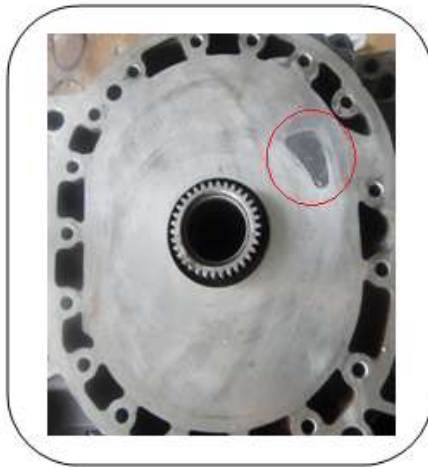
Gráfico 5.19 Sellado del estator lateral
