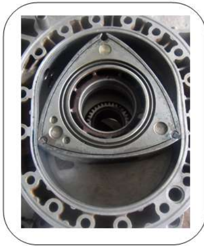
Gráfico 5.21 Colocación del rotor en su volumen máximo
