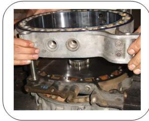
Gráfico 3.36 Instalación del estator periférico
