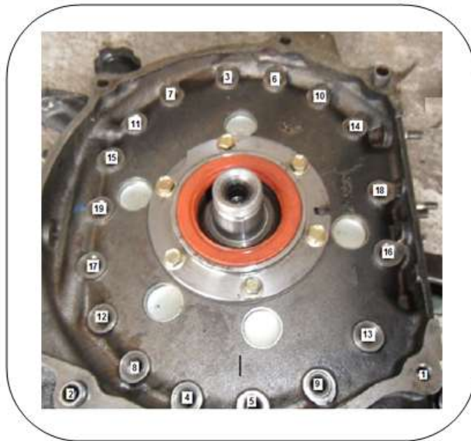
Gráfico 3.19 Orden de sacar o desajustar los pernos del motor
