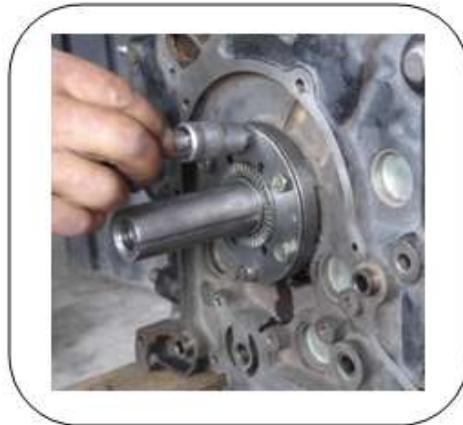
Gráfico 3.47 Ajuste de placa de apoyo
