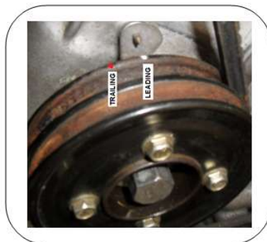
Gráfico 5.34 Señales de la polea Leading y Trailing
