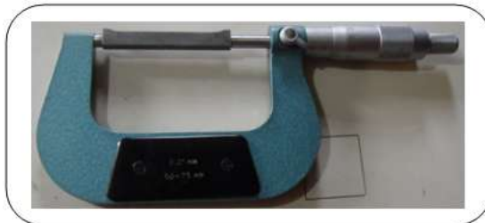
Gráfico 5.12 Toma de medida del ápex para su reposición
