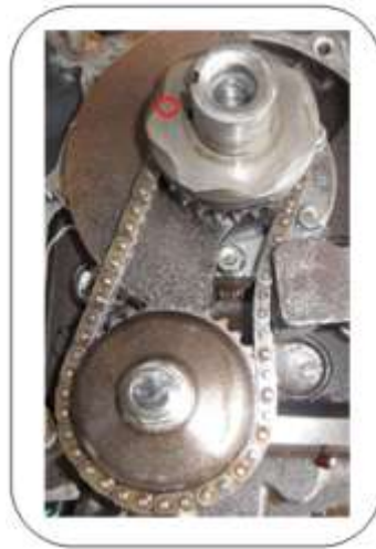
Gráfico 3.52 Señalización del engranaje de accionamiento distribuidor
