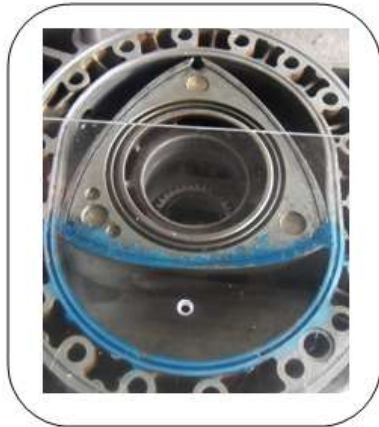
Gráfico 5.23 Placa de acrílico para la toma de medida exacta del volumen
