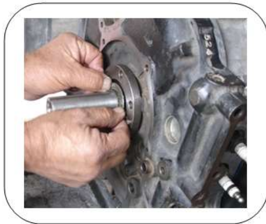
Gráfico 3.46 Placa de empuje, espaciador y canastilla del eje motriz
