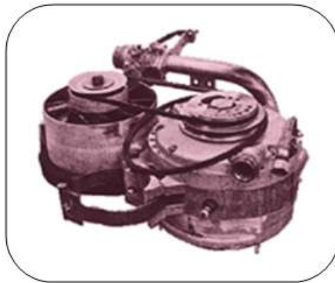
Gráfico 1.1 Prototipo motor wankel KKM 1
