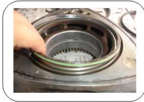
Gráfico 3.29 Montaje del retenedor de aceite externo
