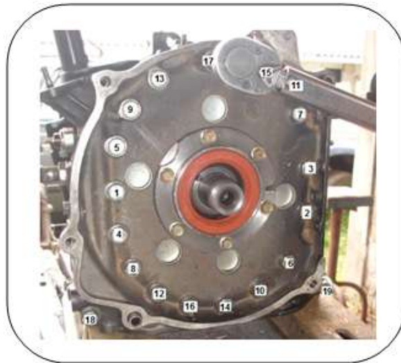
Gráfico 3.44 Orden de ajuste de los pernos del motor
