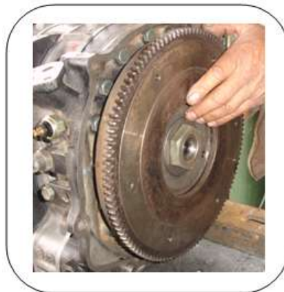
Gráfico 3.45 Instalación del volante de inercia
