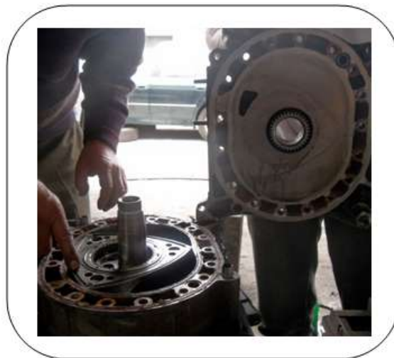
Gráfico 3.20 Desmontaje Rotor lateral
