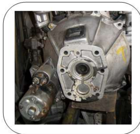
Gráfico 3.60 Parte posterior del motor con motor de arranque
