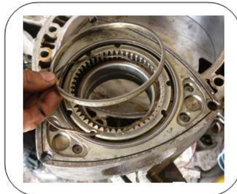
Gráfico 3.24 Desmontaje sello de aceite del rotor
