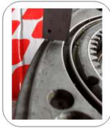
Gráfico 5.14 Toma de medida del pronunciado del segmento lateral
