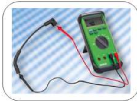
Gráfico 5.37 Comprobación de los cables de bujías 120
