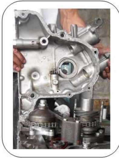
Gráfico 3.54 Instalación de la tapa frontal
