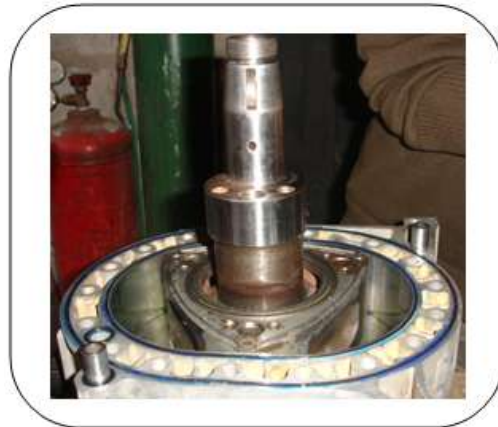
Gráfico 3.39 Verificación del giro del rotor
