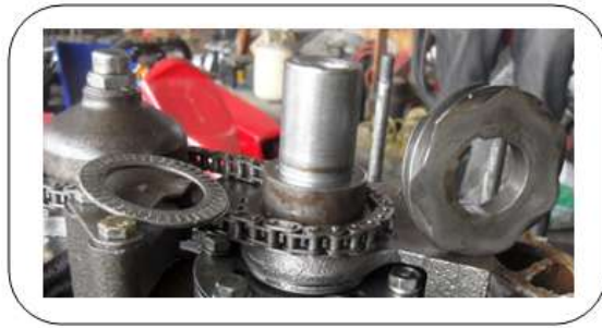
Gráfico 3.14 Engranaje distribuidor y canastilla
