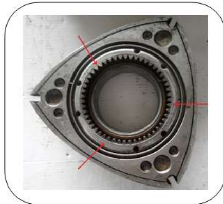
Gráfico 5.7 Puntos para la toma de medida del rotor
