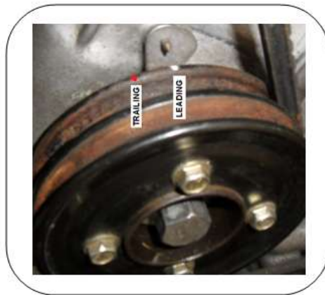
Gráfico 5.28 Señales de la polea Leading y Trailing
