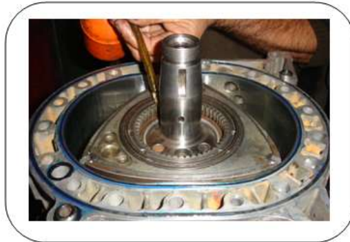
Gráfico 3.42 Untar aceite en rodamientos y piñones
