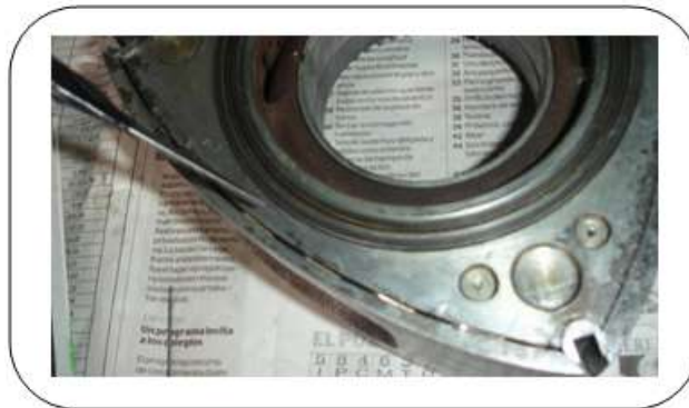
Gráfico 3.31 Montaje del muelle del segmento lateral
