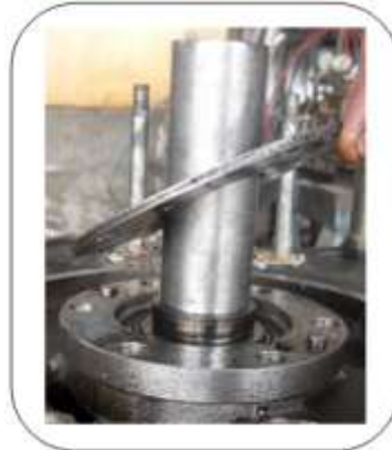
Gráfico 3.18 Desmontaje placa de apoyo del contrapeso
