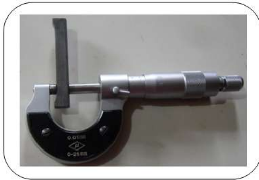
Gráfico 5.10 Toma de medida de la altura del segmento periférico
