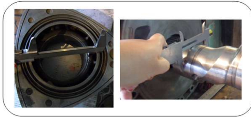
Gráfico 5.8 Toma de medida de diámetro interno y externo
