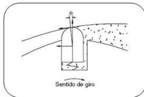
Gráfico 2.7 Sentido de giro del segmento periférico 16
