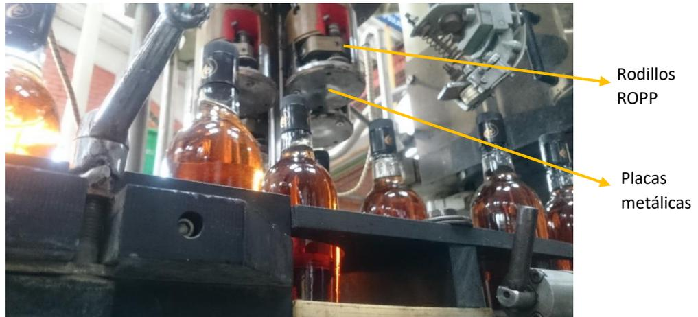
Figura 1.18: Fotografía de la máquina ROPP con placas metálicas
