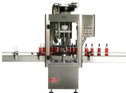
Figura 1.3: Máquina automática de tapado a presión
