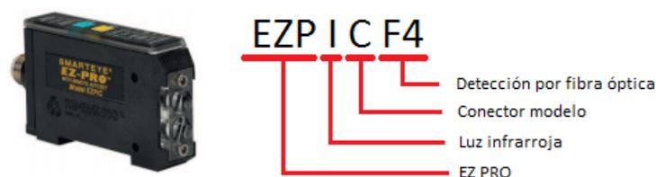
Figura 3.21: Número de parte del sensor fotoeléctrico seleccionado
