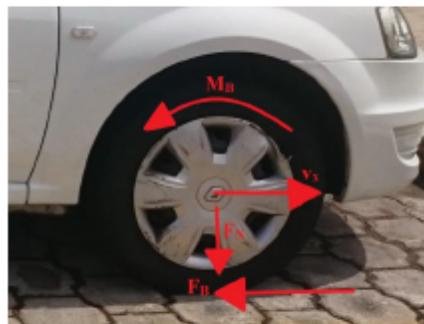
Figura 1.10: Velocidad del neumático y fuerzas que influyen en el frenado
