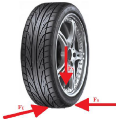
Figura 1.9: Componentes de las fuerzas del neumático Fuente: Tamayo L.
