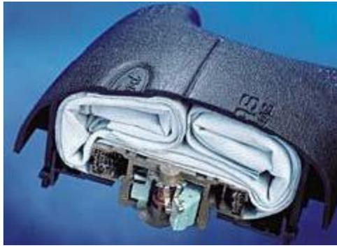
**Gráfico 1.15 Airbag del conductor**<sup>16</sup>
