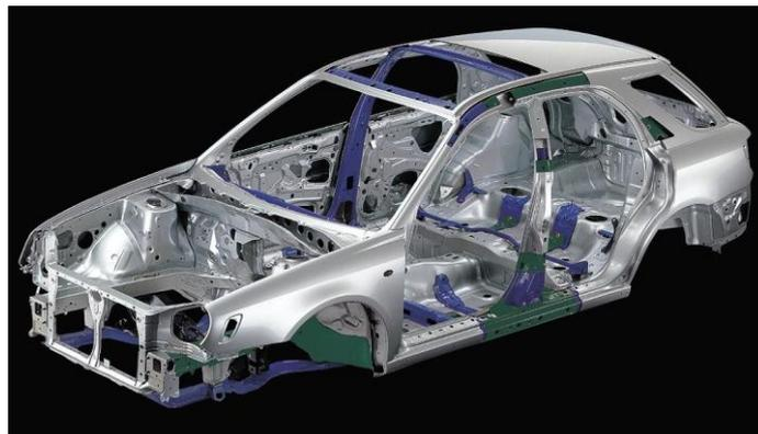
**Gráfico 1.7 Carrocería de deformación programada** <sup>7</sup>
