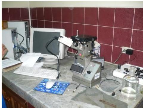
**Gráfico 2.4 Microscopio Metalográfico**
