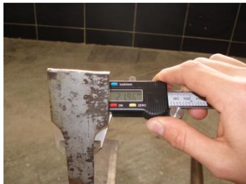
**Gráfico 2.15 Medidas de la probeta (extremo)**
