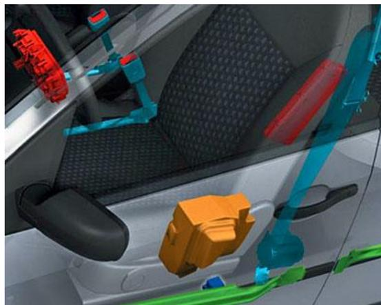
**Gráfico 1.12 Limitador de tensión cinturón de seguridad** <sup>13</sup>
