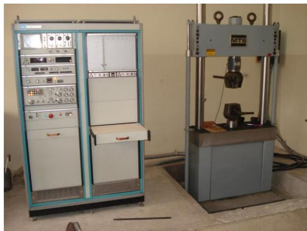
**Gráfico 2.12 Máquina de Ensayo de Tracción**
