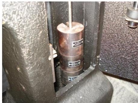
**Gráfico 2.10 Cargas utilizadas en la prueba de dureza**
