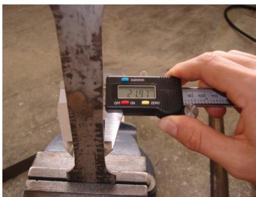
**Gráfico 2.17 Medidas de la probeta (extremo)**
