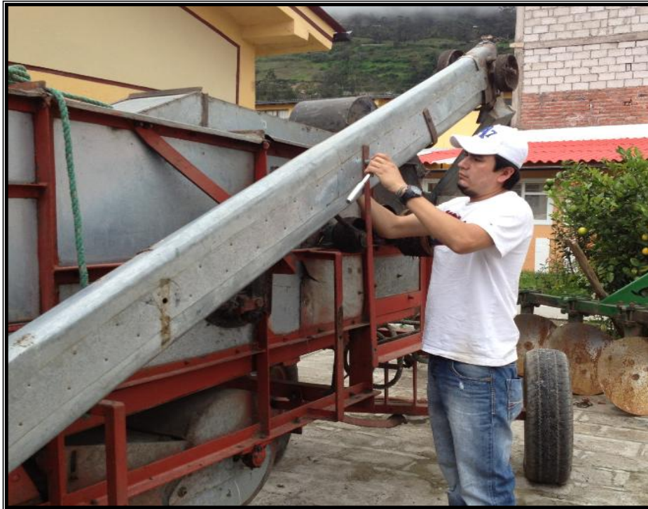
Figura 3.20. Elevador de retrillado sellado
