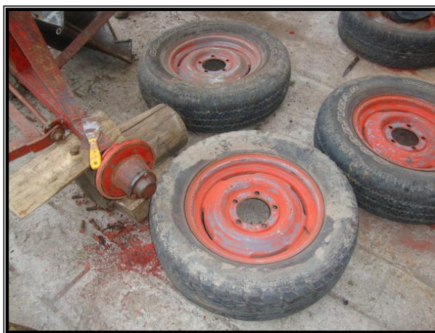
Figura 4.20. Llantas y aros deteriorados
