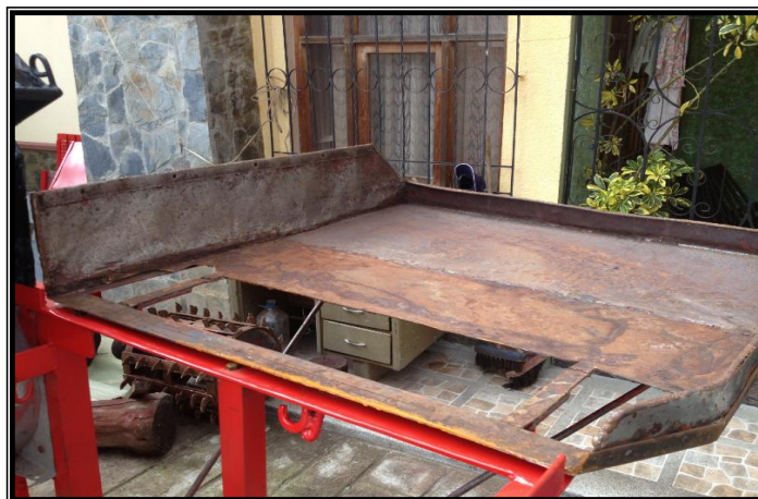
Figura 4.19. Tolva de ingreso en mal estado
