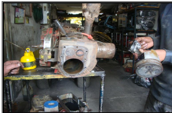
Figura 4.27. Inspección de pistón y segmentos
