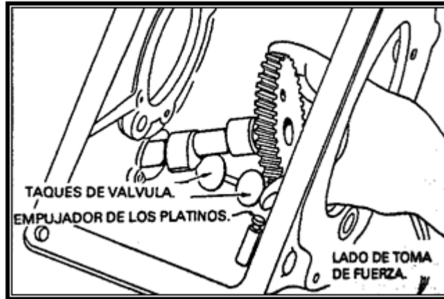
Figura 4.54. Desmontaje y montaje del piñón árbol de levas
