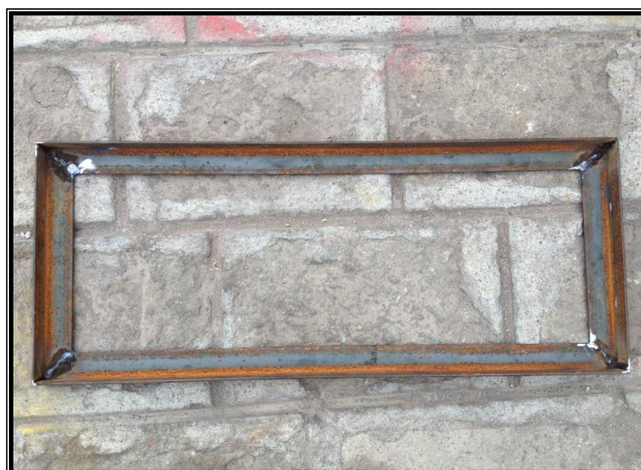
Figura 4.59. Estructura tipo mesa apoyo motor
