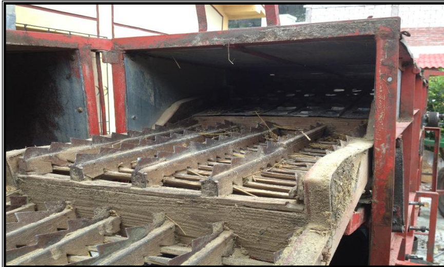
Figura 4.7. Oxidación y humedad en Saca pajas
