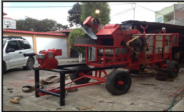
Figura 4.65. Adaptación del motor a la trilladora
