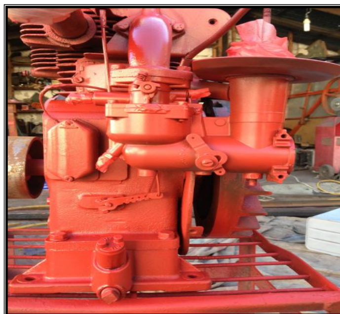
Figura 4.56. Carburador reparado y acondicionado
