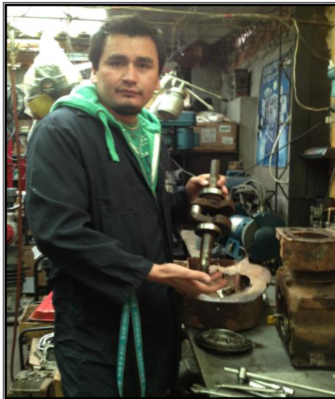
Figura 4.28. Inspección de cigüeñal y apoyos
