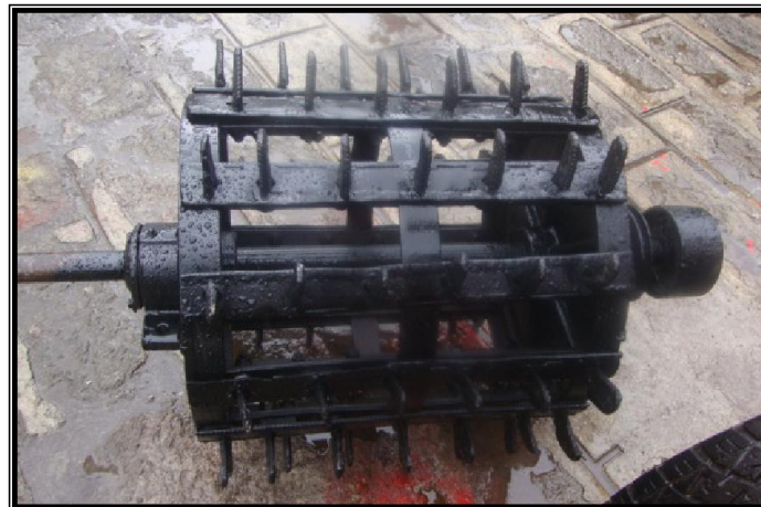
Figura 4.40. Cilindro desgranador reconstruido
