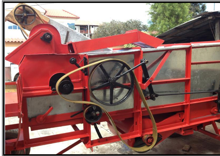
Figura 4.41. Instalación de bandas y poleas
