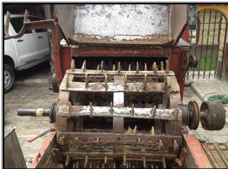
Figura 4.14. Cilindro de dientes deteriorado
