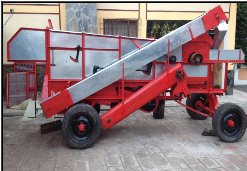
Figura 4.43. Maquina trilladora Friedrich 300 reconstruida
