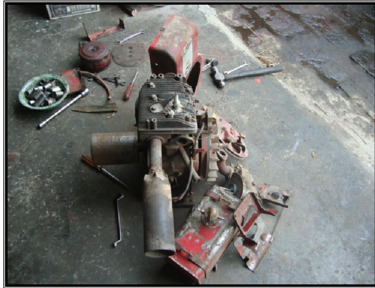
Figura 4.23. Partes externas del motor en mal estado
