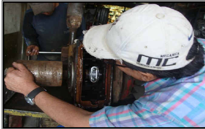
Figura 4.26. Inspección de cigüeñal y biela
