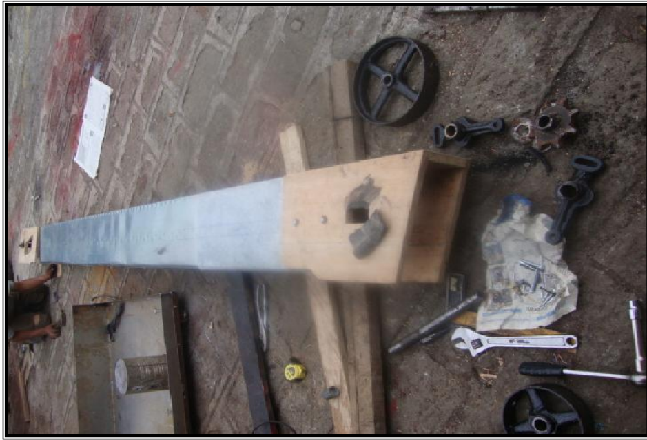
Figura 4.42. Construcción de elevador de retrillado
