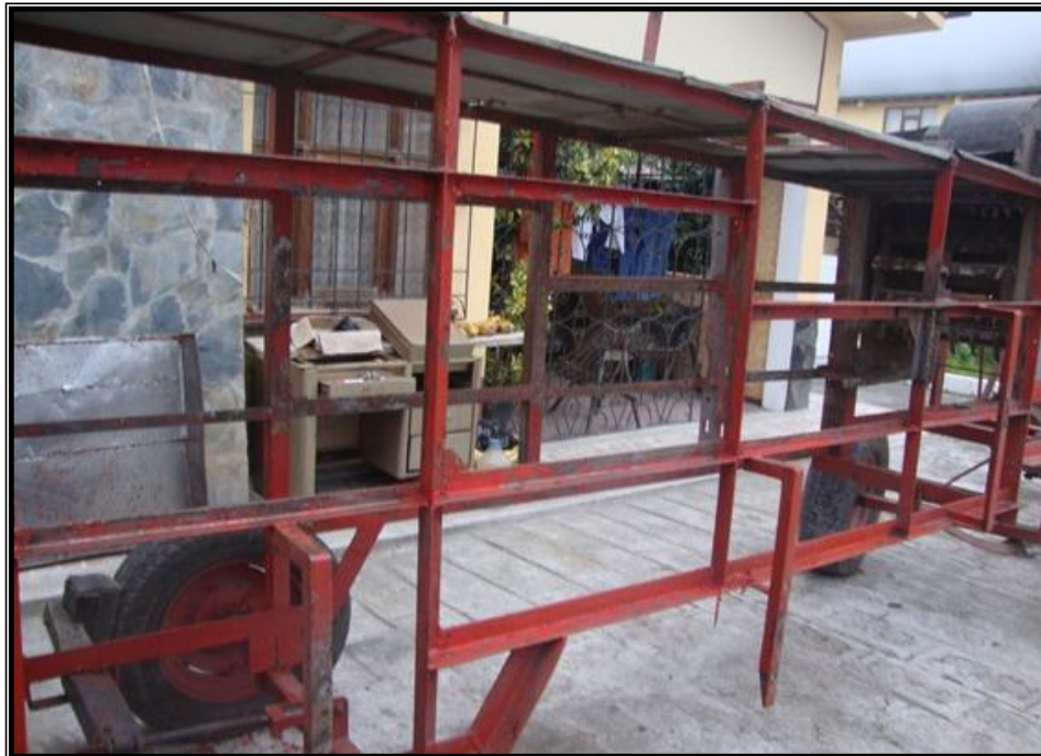
Figura 3.1. Estructura en chapa de acero
