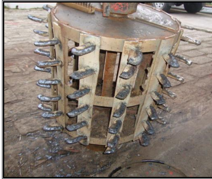
Figura 4.38. Reparación de cilindro desgranador
