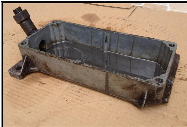
Figura 4.24. Cárter inferior del motor dañado
