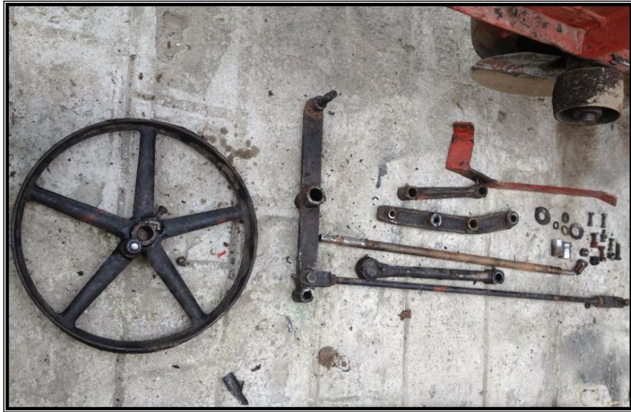
Figura 4.4. Polea de mando, brazos y articulaciones dañadas
