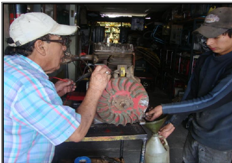
Figura 4.25. Drenaje de aceite lubricante e inspección visual
