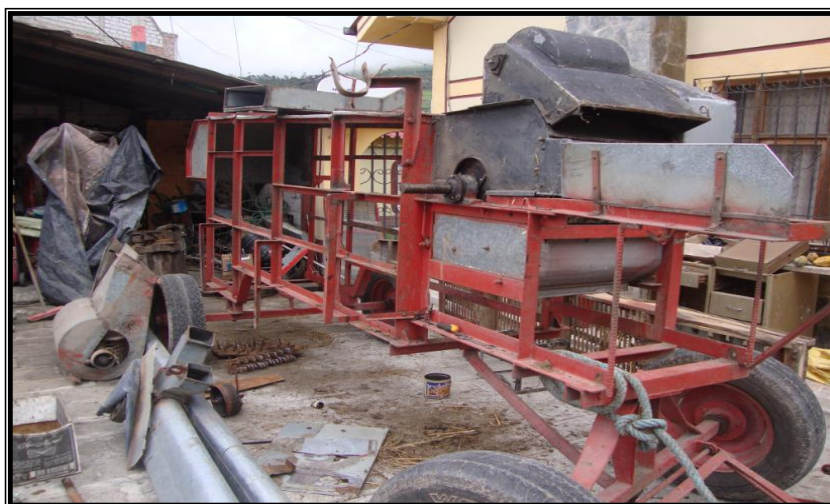
Figura 4.11. Estructura, cabezal y cóncavo deteriorados
