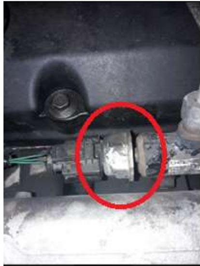
**Figura 31:** Sensor de Presión del Riel (RPS)
