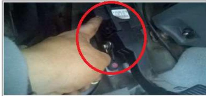
**Figura 71:** Sensor de Posición del Acelerador (APS)
