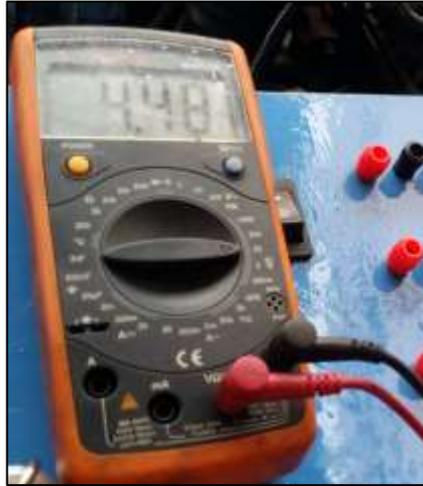
**Figura 14:** Comprobación la referencia del voltaje al ECTS
