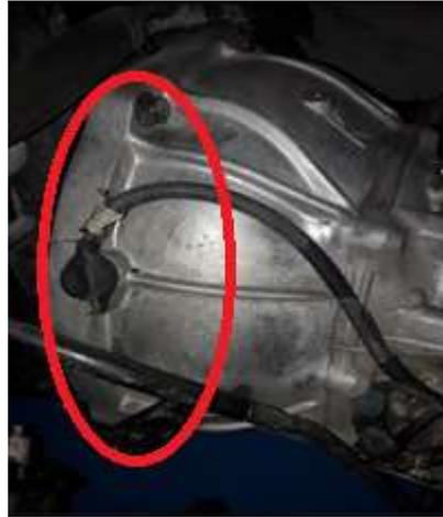
**Figura 26:** Sensor de Posición del Cigüeñal (CKPS)
