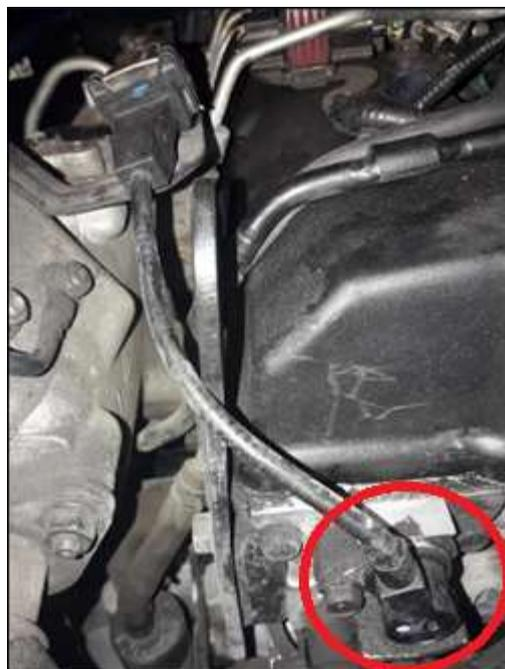
**Figura 19:** Sensor de Posición del Árbol de Levas (CMPS)
