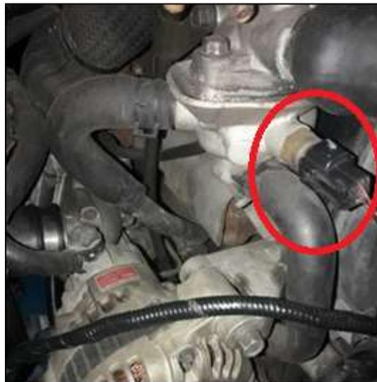
**Figura 11:** Sensor de Temperatura del Refrigerante del Motor
