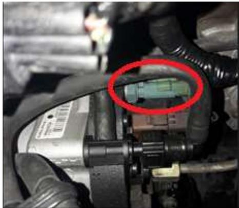
**Figura 44:** Sensor de Temperatura de Combustible (FTS)
