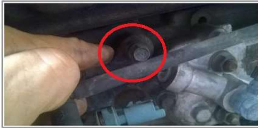
**Figura 38:** Sensor de Detonación
