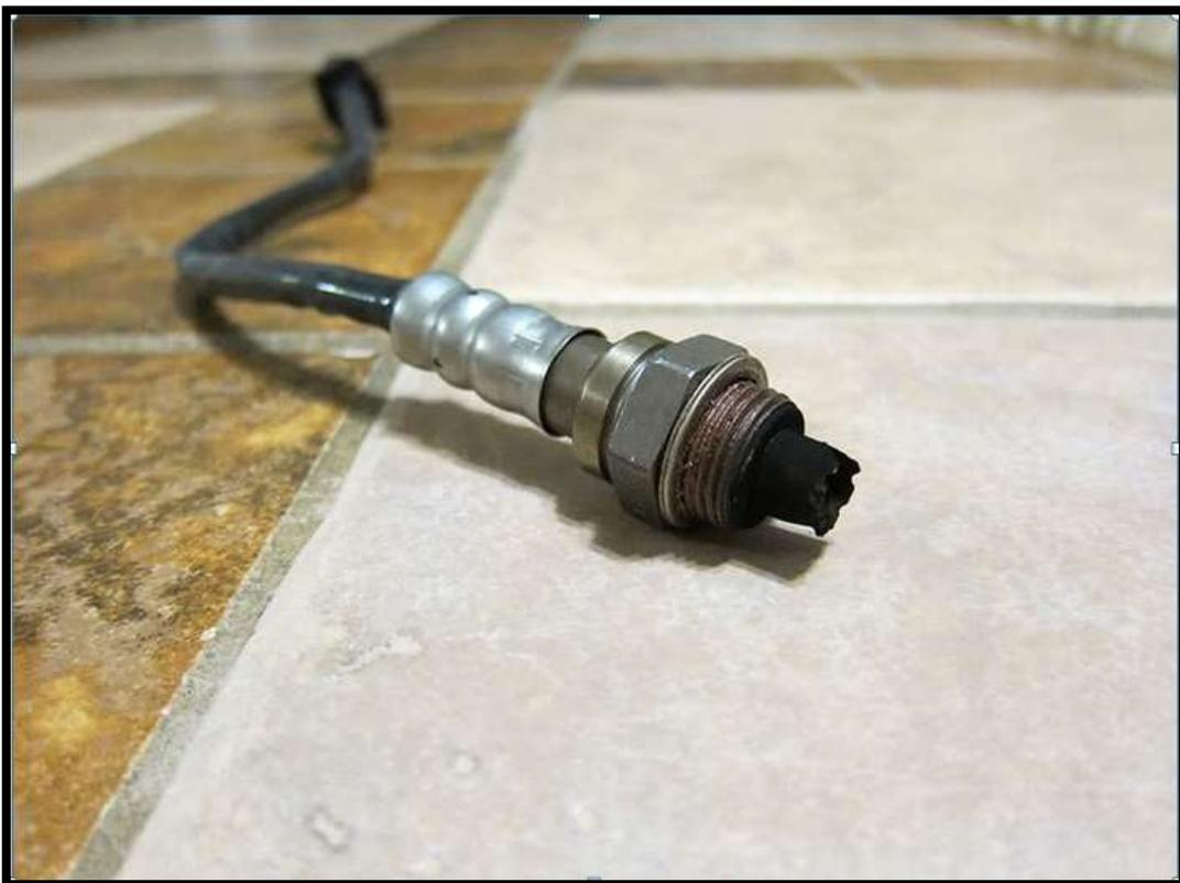
Fig.47 Sensor De Oxigeno Dañado
