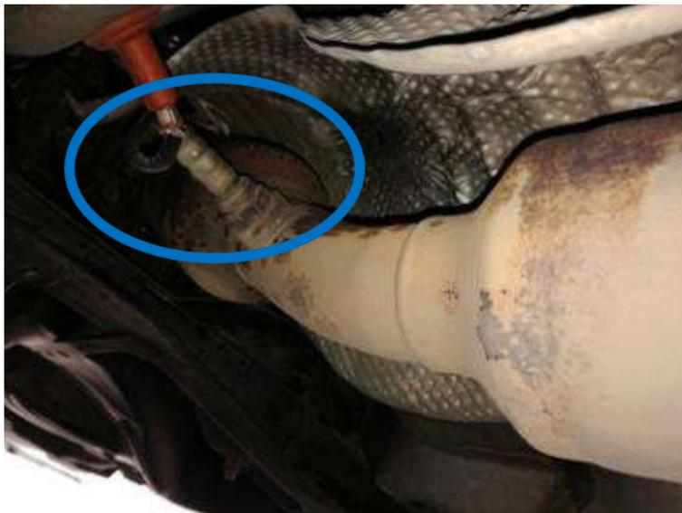
Fig.38 Sensor de Oxigeno B1S2
