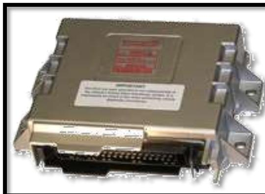
FIGURA 25. Unidad de control de motor (ECU)
