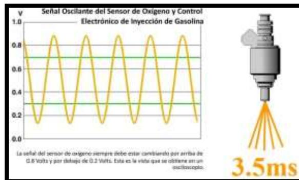
Figura 23. Señal de sensor de oxígeno
